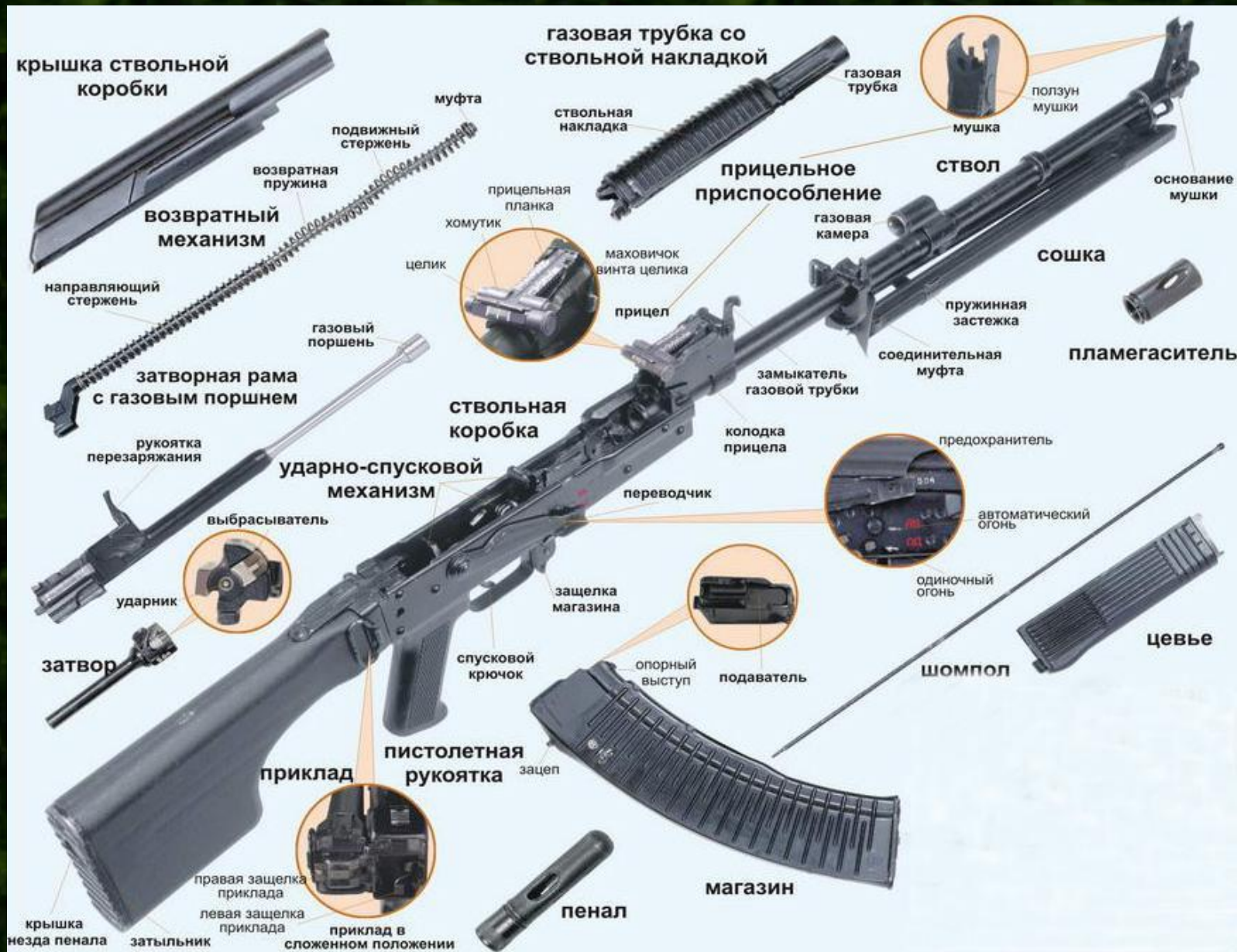
Рис. 6. Основные части и механизмы РПК-74
