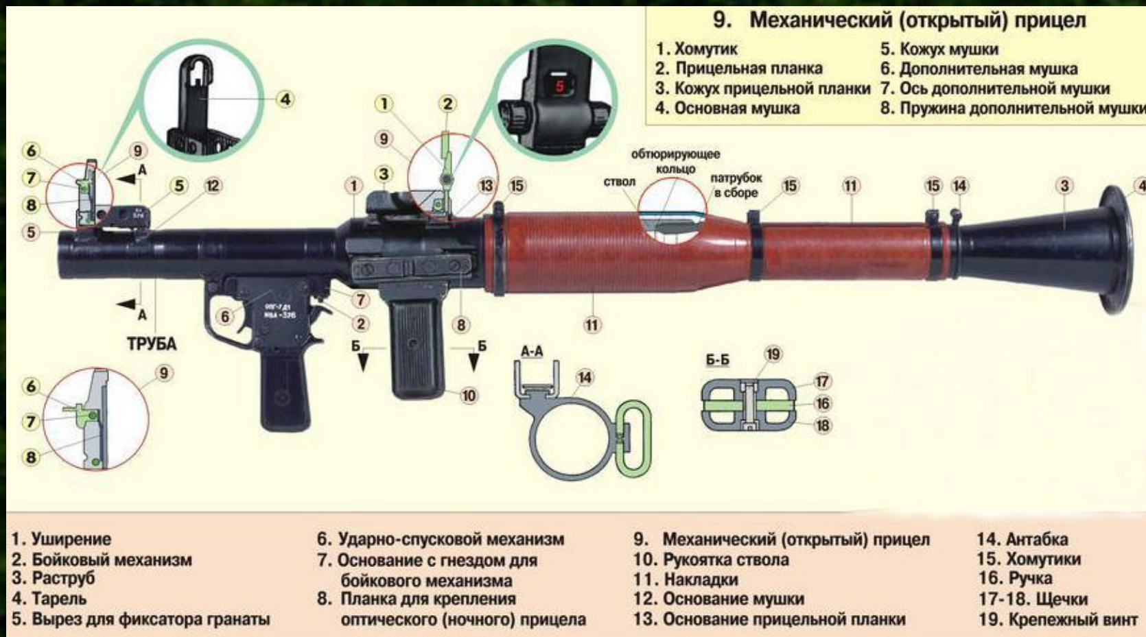
Рис. 13. Части и механизмы РПГ-7
