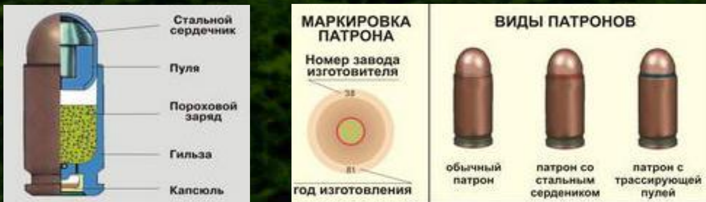
Рис. 12. Общий вид и устройство 9-мм пистолетного патрона к ПМ
