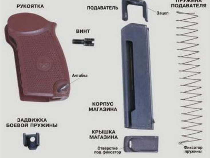
Рис. 11. Основные части и механизмы ПМ
