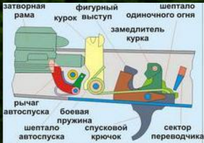
Рис. 8. Ударно-спусковой механизм АК-74 и РПК-74
