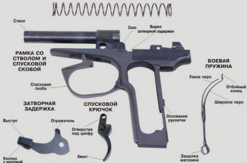
Рис. 11. Основные части и механизмы ПМ
