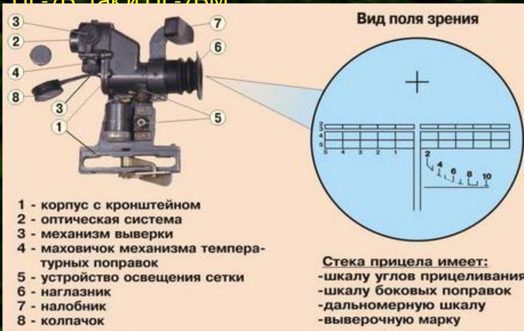
Рис. 14. Устройство и сетка оптического прицела
