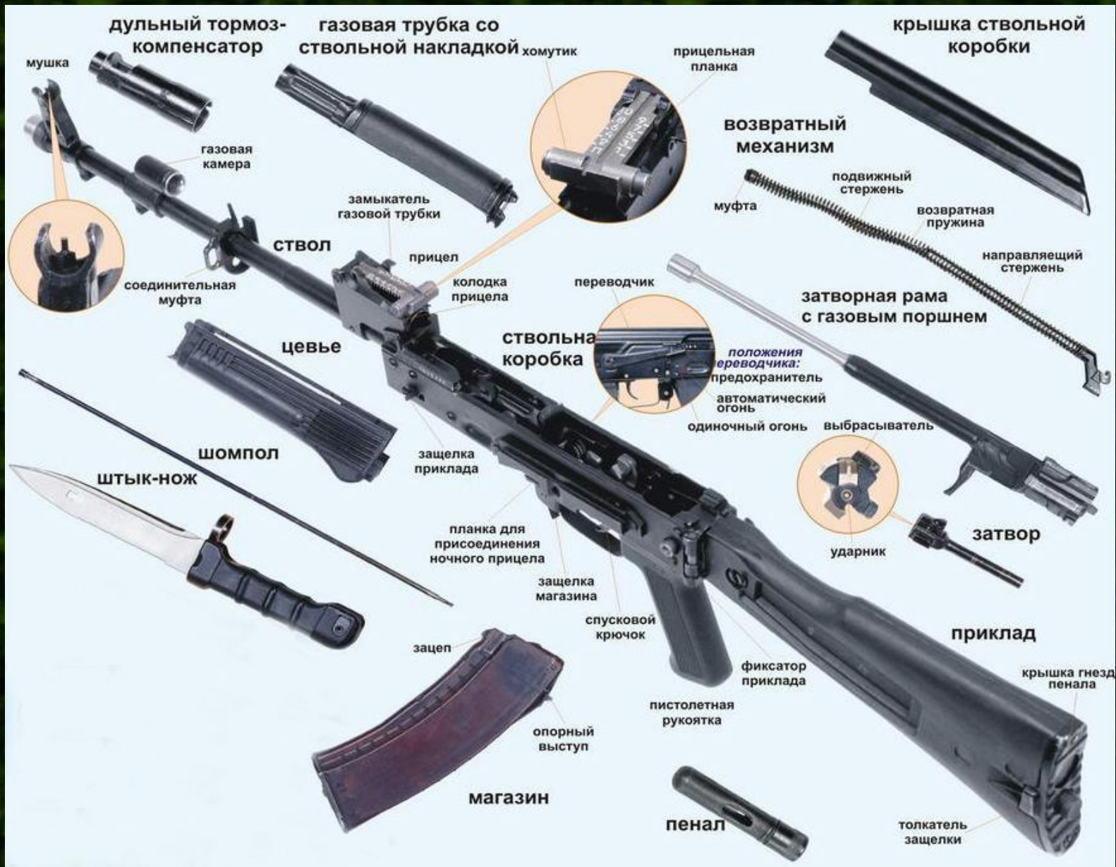
Рис. 5. Основные части и механизмы АК-74
