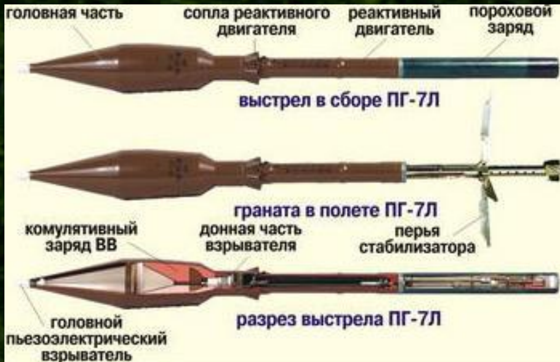
Рис. 15 б. Устройство выстрела к РПГ-7
