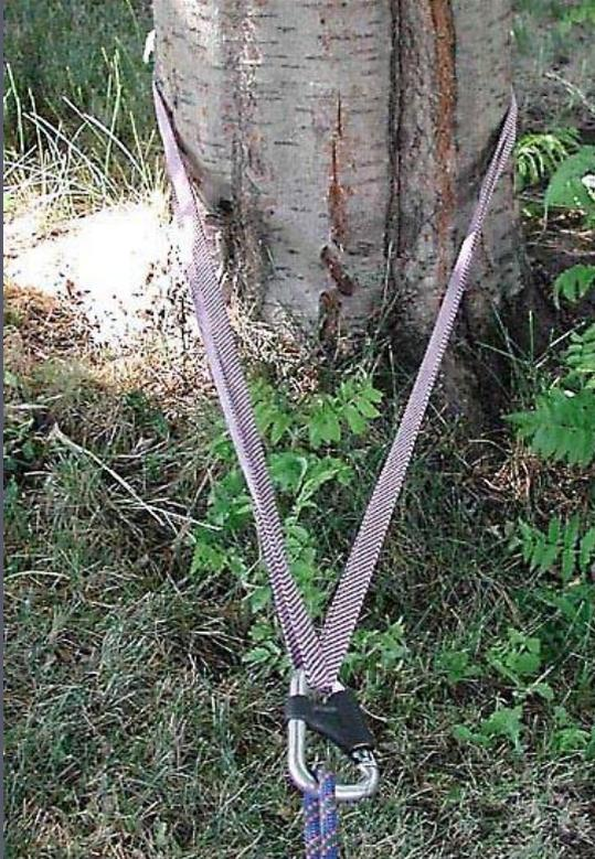
Распределение нагрузки на четыре нити петли. Идеальный угол в этой ситуации – около 25 градусов. Это уменьшает нагрузку на петлю и карабин, а также снижает вероятность нагрузить карабин в трех направлениях. Для дальнейшего уменьшения риска неправильной нагрузки, использован специальный карабин.
