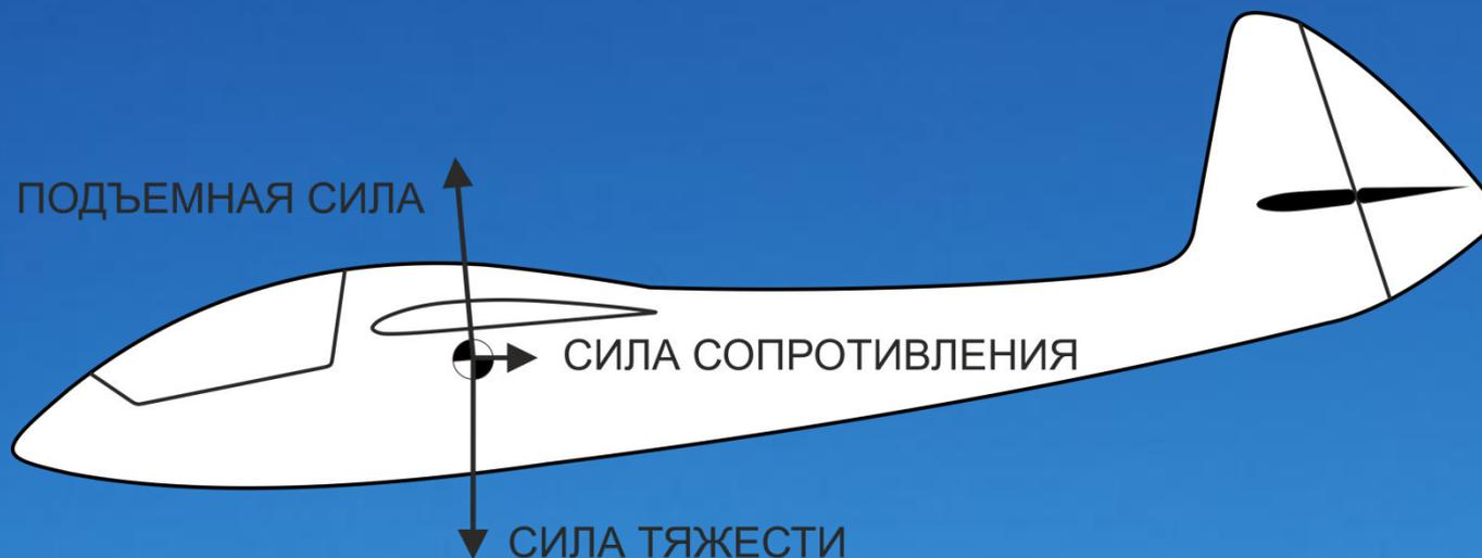
Но, кроме трех основных сил еще есть небольшие силы, которые действуют на управляющие поверхности планера: Стабилизатор, Киль, Руль высоты, руль направления и элероны. Они возникают только в те моменты, когда управляющие поверхности посредством тяг и тросов отгибаются в ту или иную сторону.
