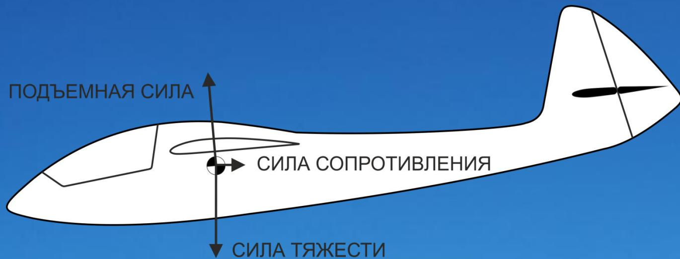
Но, кроме трех основных сил еще есть небольшие силы, которые действуют на управляющие поверхности планера: Стабилизатор, Киль, Руль высоты, руль направления и элероны. Они возникают только в те моменты, когда управляющие поверхности посредством тяг и тросов отгибаются в ту или иную сторону.
