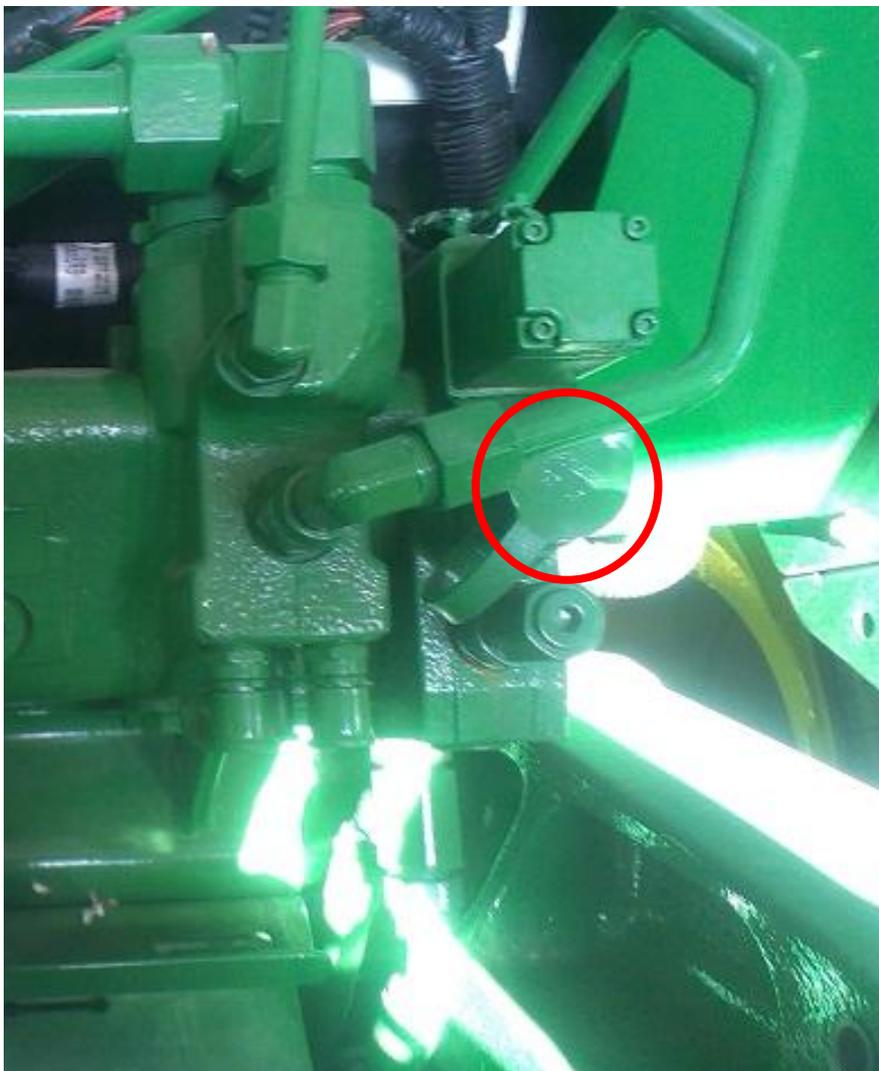
Опускание навески вручную возможно при отсутствии гидравлического давления и/или электропитания.
