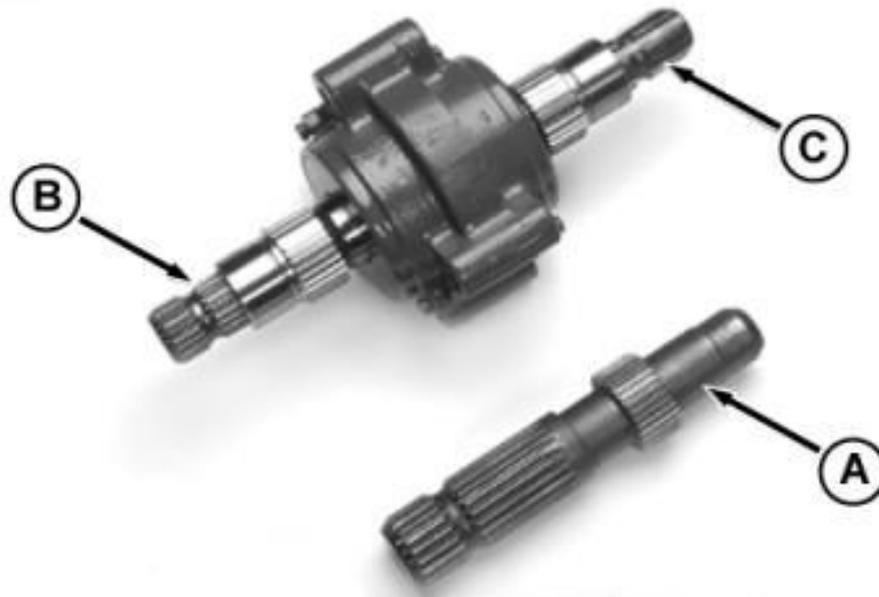
Тракторы оснащены 45-мм (1-3/4—дюйм.) валом (А) ВОМ. Для больших нагрузок ВОМ требуется прочность этого большого вала с 20 шлицами.
