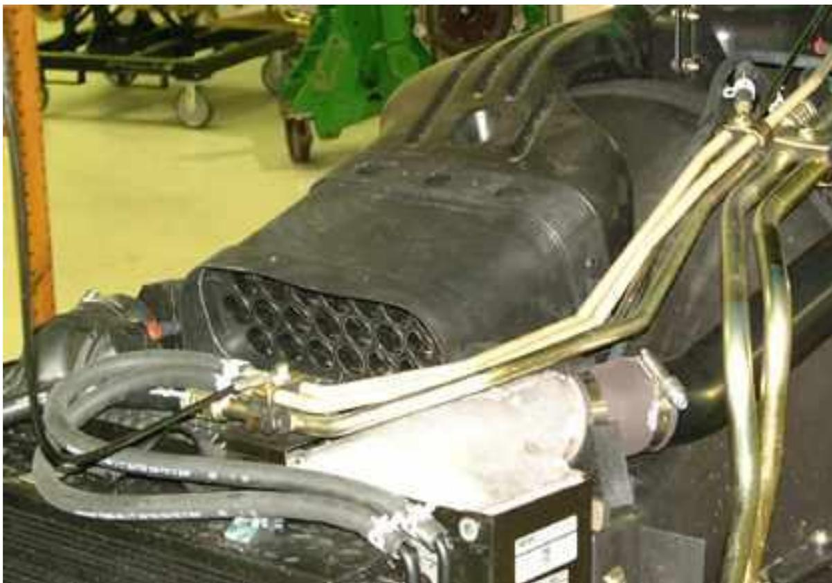
Снять предочиститель с трактора, поворачивая его и сдвигая со впускного отверстия кожуха.
