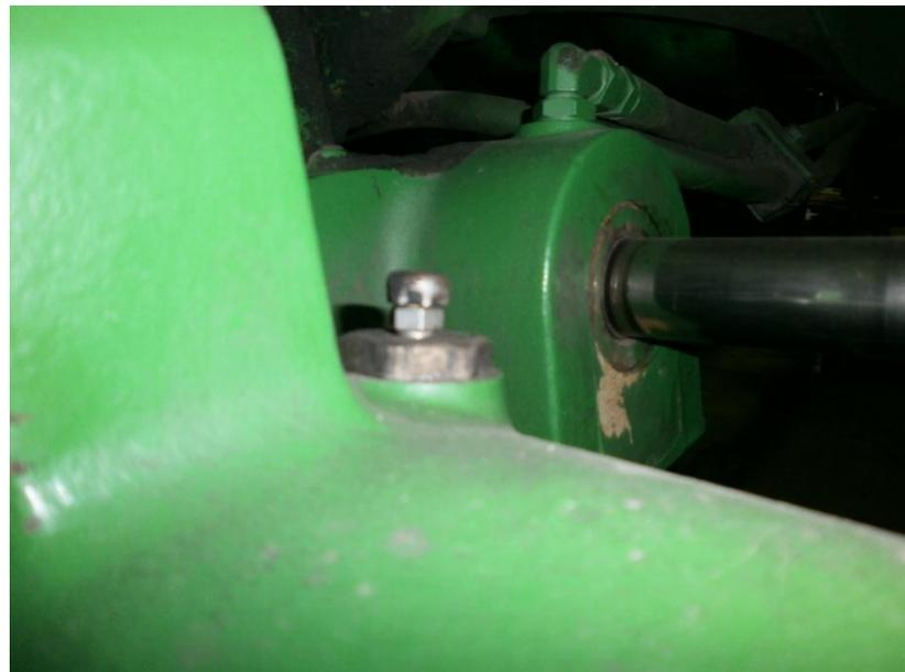
Снять стравливающий фильтр моста. Очистить, продувая воздух через стравливающий фильтр (снизу вверх).
