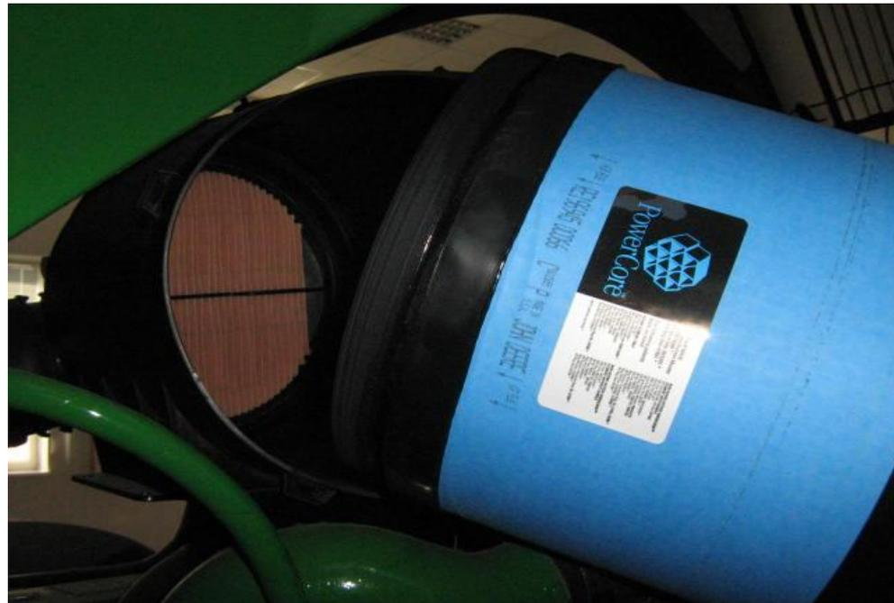
Если индикаторная лампочка фильтра остается **ВКЛЮЧЕННОЙ**, замените фильтр предварительной очистки воздуха, поступающего в двигатель.
