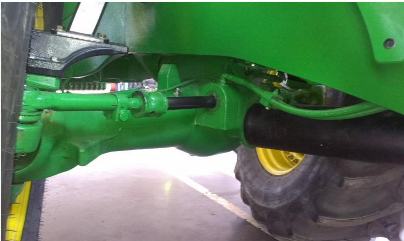
1. Ослабьте стопорную гайку на правой и левой поперечных рулевых тягах.
