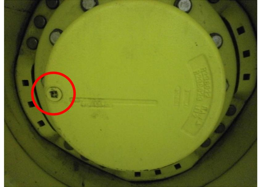
Извлечь пробку, уровень масла должен быть как раз под отверстием для пробки.
