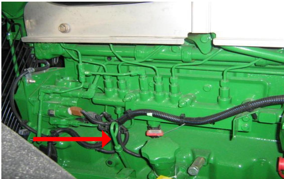
Установив трактор на ровной площадке, извлеките масляный щуп и произведите проверку уровня масла в двигателе. Уровень масла должен находиться между отметкой “ADD” (ДОБАВИТЬ) и верхней частью заштрихованной области на масляном щупе.
