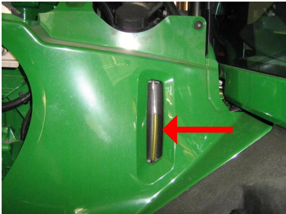
ПЕРЕД запуском трактора проверьте уровень охлаждающей жидкости по трубчатому уровнемеру. При холодном двигателе уровень должен быть немного выше нижней отметки.
