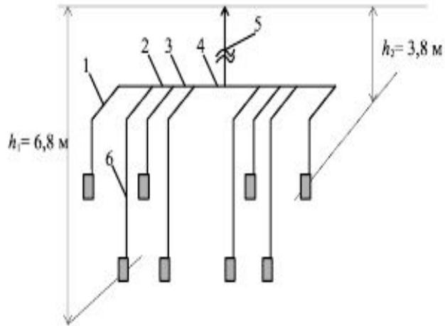
Рис. 2.1. Схема вытяжной естественной вентиляции
