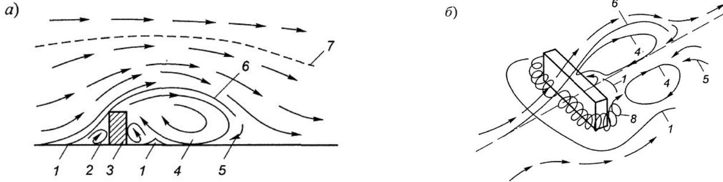
Рис. 14.1. Схема обтекания здания потоком воздуха
