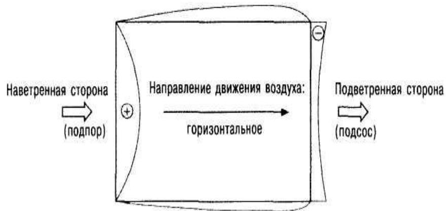
Движение воздуха в помещениях и зданиях при плотности отходящего воздуха больше плотности наружного воздуха  $\rho_{AB} > \rho_{AU}$ : AU — наружный воздух, AB — вытяжной (уходящий) воздух, ZU — приточный воздух, FO — удаляемый (сбросной) воздух.
