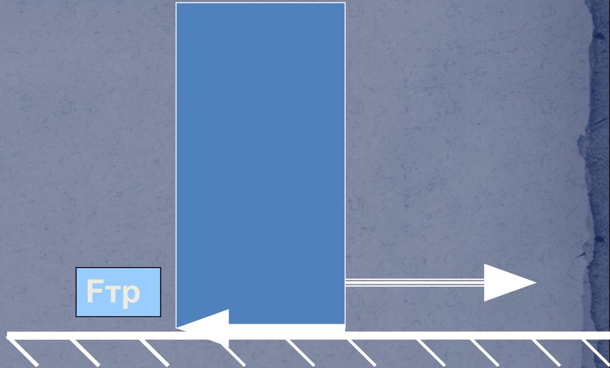
Когда тело начинает двигаться по опоре, возникает сила трения, направленная в сторону, противоположную движению.
