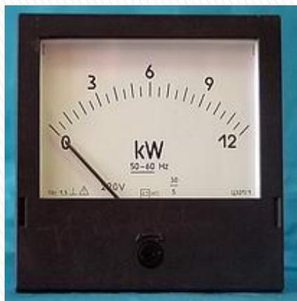
Ваттметр – измерительный прибор предназначенный для измерения мощности электрического тока или электромагнитного сигнала.
