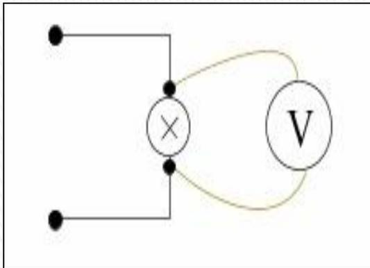
Сопротивление вольтметра должно быть большим по сравнению с сопротивлением приемника энергии (генератора), параллельно которому он включается с тем, чтобы его включение не влияло на измеряемое напряжение (на режим работы цепи).
