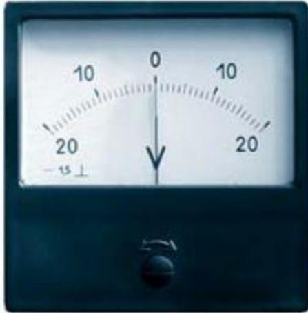
Вольтметр – измерительный прибор для определения «напряжения» или ЭДС (электродвижущая сила) в электрических цепях. Показание вольтметра определяется напряжением на его зажимах. Поэтому для измерения напряжения на зажимах приемника или генератора необходимо его зажимы соединить с зажимами вольтметра, т.е. присоединить вольтметр параллельно потребителю или генератору по схеме.
