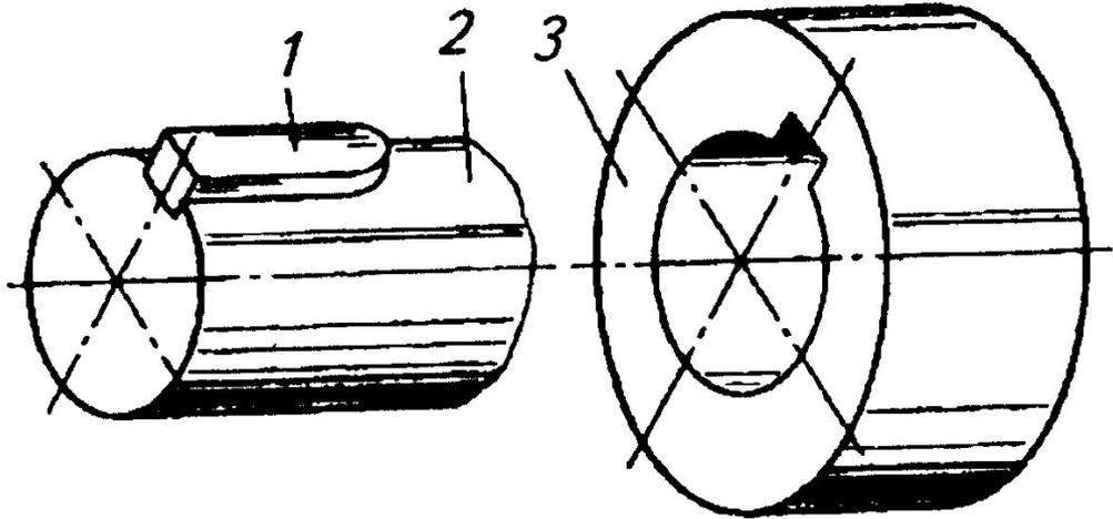
Шпоночное соединение образуют шпонка 1, вал 2 и ступица 3 колеса (шкива, звездочки и др.).
