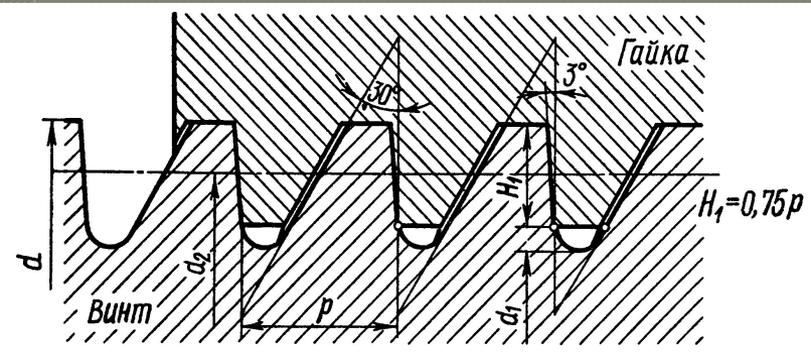
**Упорная резьба** – имеет профиль в виде неравнобокой трапеции с углом  $\alpha = 27^\circ$ .
