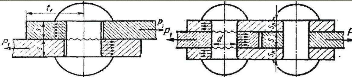
Детали, соединяемые заклепками, в большинстве случаев находятся под действием сил, стремящихся сдвинуть одну деталь относительно другой.
