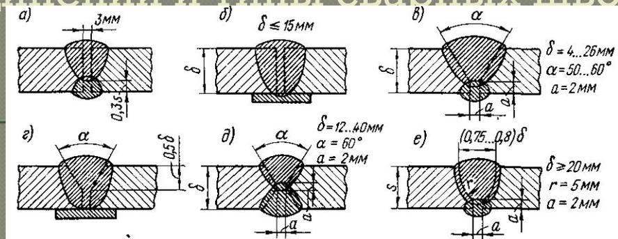
В зависимости от расположения соединяемых частей различают следующие виды сварных соединений: *стыковые* (рис. 3.1, о... е), *нахлестанные* (рис. 3.2, а...г), *с накладками* (рис. 3.3), *угловые* (рис. 3.4, а...е), *тавровые* (рис. 3.5,а...г).
