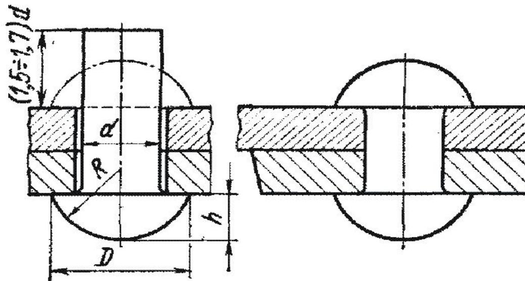
Образуются с помощью специальных деталей – заклёпок. Заклёпка имеет грибообразную форму и выпускается с одной головкой (закладной) вставляется в совместно просверленные детали, а затем хвостовик ударами молотка или прессы расклёпывается, образуя вторую головку (замыкающую). При этом детали сильно сжимаются, образуя прочное, неподвижное неразъёмное соединение.
