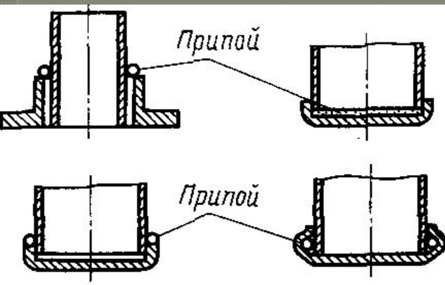
По конструкции паяные соединения подобны сварным и клеевым.
