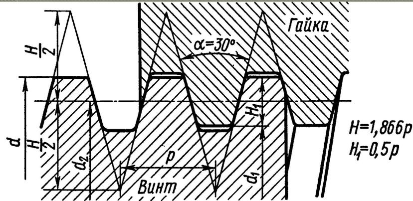
**Трапецидальная резьба.** Это основная резьба в передаче винт – гайка. Ее профиль равнобедренная трапеция с углом  $\alpha = 30^\circ$ . Характеризуется небольшими потерями на трение с треугольным профилем.
