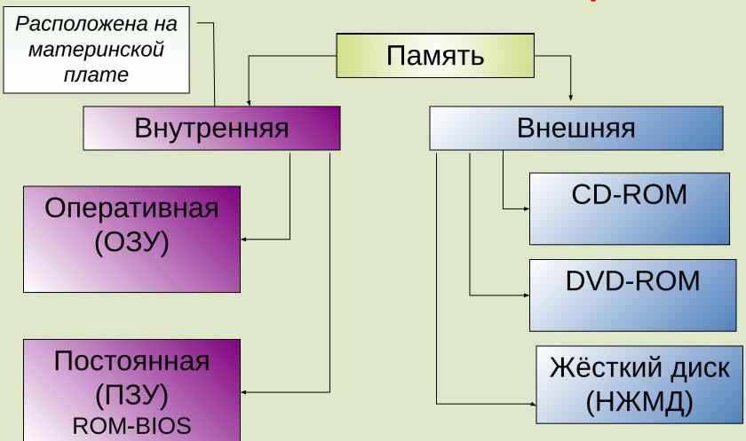
Объем ОП колеблется в пределах от 64 Кб до 64 Мб и выше, как правило, ОП имеет модульную структуру и может расширяться за счет добавления новых микросхем.
