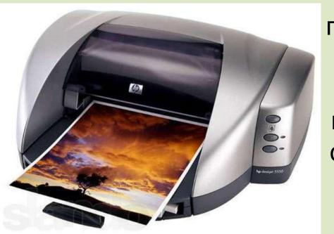
Принтеры — это устройства вывода данных из ЭВМ, преобразовывающие ормационные ASCIIкоды в соответствующие им графические символы и фиксирующие эти символы на бумаге. Принтеры наиболее развитая группа внешних устройств, насчитывается более 1000
