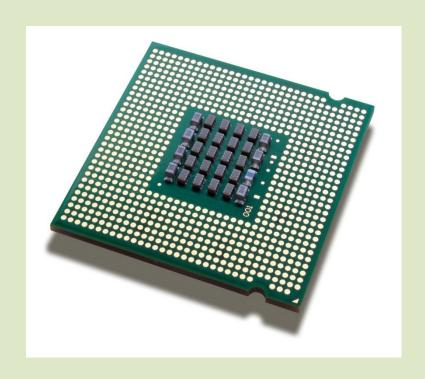
3. Процессор (CPU центральный процессор) – это главный вычислительный элемент персонального компьютера. Все программы состоят из огромной последовательности микрокоманд, и именно процессор выполняет эти команды
