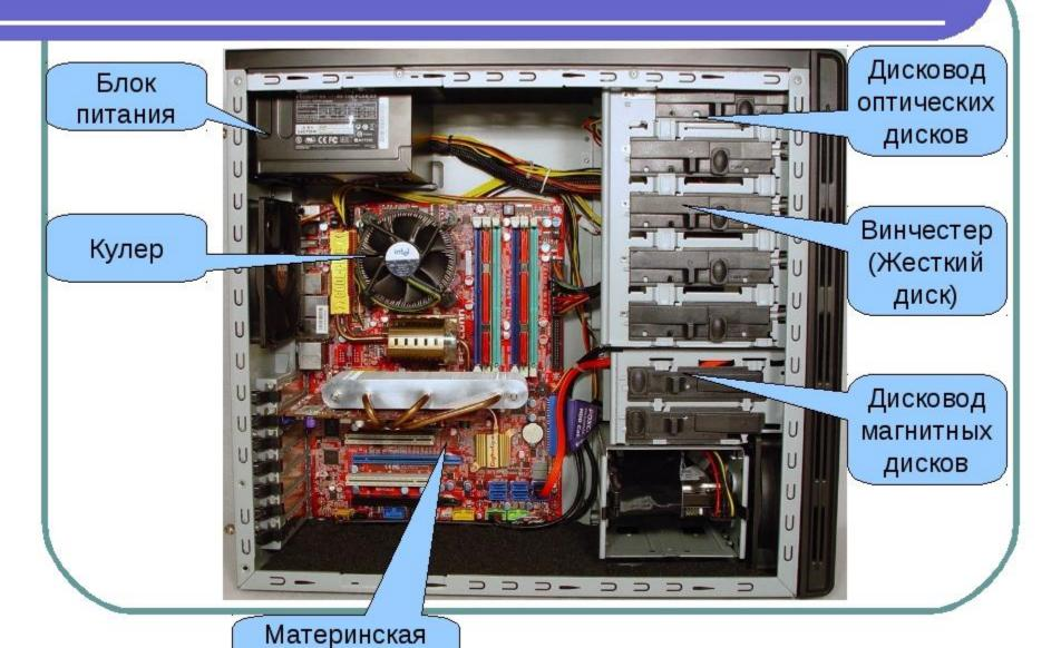
Системный блок (разг. корпус, системник) — это элемент персонального компьютера, который защищает компоненты компьютера, находящиеся внутри, от механических повреждений и внешнего воздействия.
