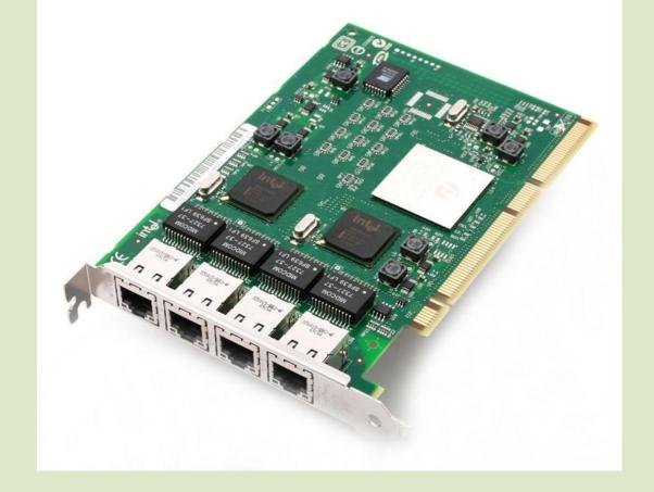
8. **Сетевая карта** – элемент системного блока, необходимый для соединения компьютера с локальной сетью или сетью Интернет. Последнее время сетевые платы интегрированы (встроены) в материнские платы.
