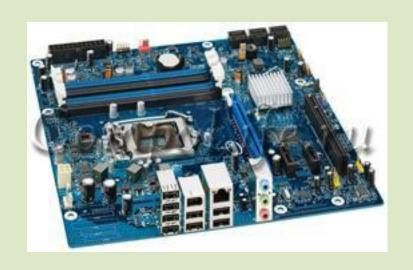
4. Материнская плата – один из компонентов ПК, который входит в число основных. Материнская плата объединяет все компоненты системного блока. Кроме этого она включает в себя дополнительные компоненты: встроенная видеокарта, сетевой адаптер, звуковая карта, устройства ввода-вывода и др.
