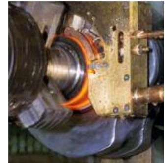
Denki Kogyo: слева – моделирование двухчастотной закалки шестерни, Справа – закалка коленвала
