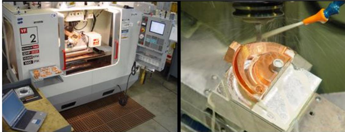
5-координатный ЧПУ станок и обработка меди индуктора
