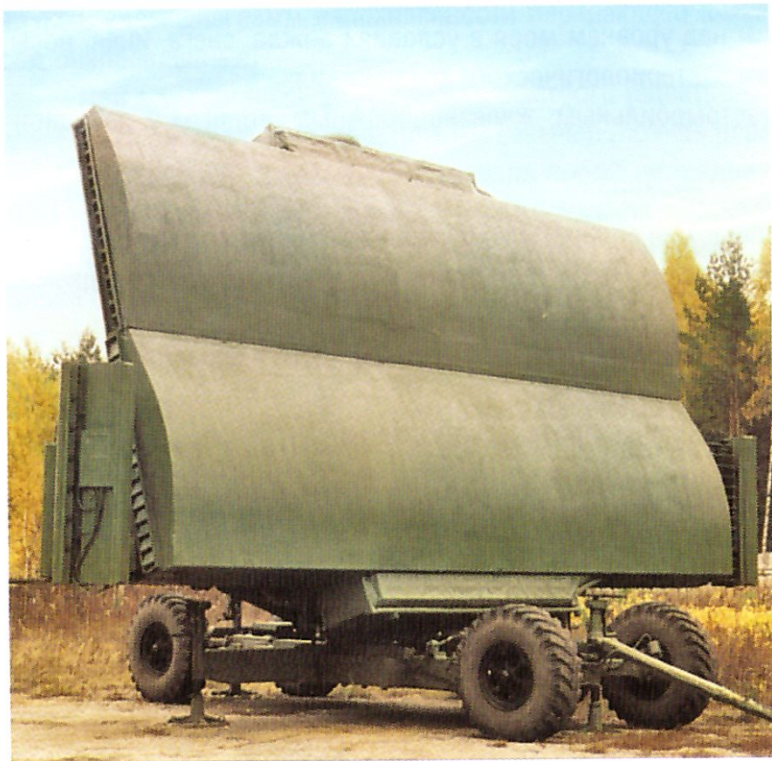
Первая отечественная полностью твердотельная РЛС с АФАР «Гамма-Д» (67Н6)
