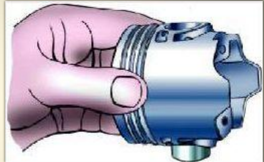
Рис. 27. Проверка посадки поршневого пальца
