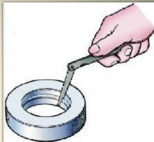
Рис. 29. Проверка зазора в замке колец
