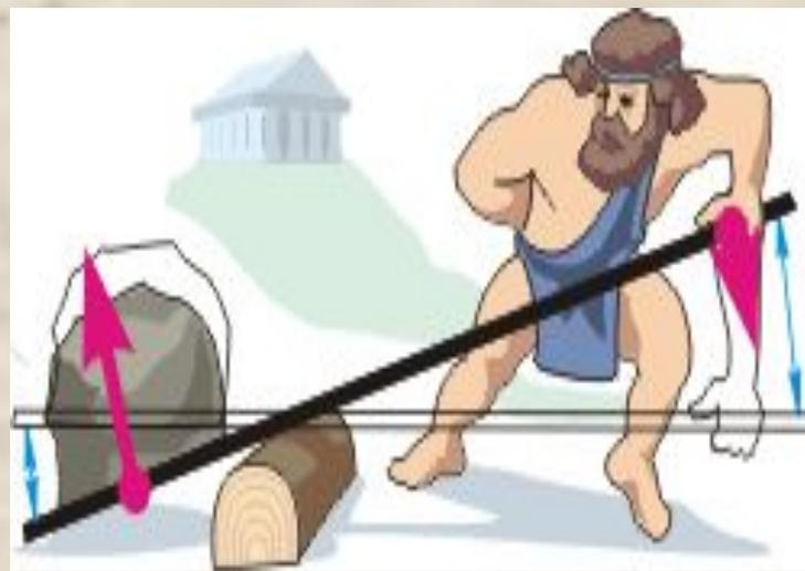
**Рычаг** – простой механизм, представляющий собой твердое тело, которое может вращаться вокруг неподвижной опоры.
