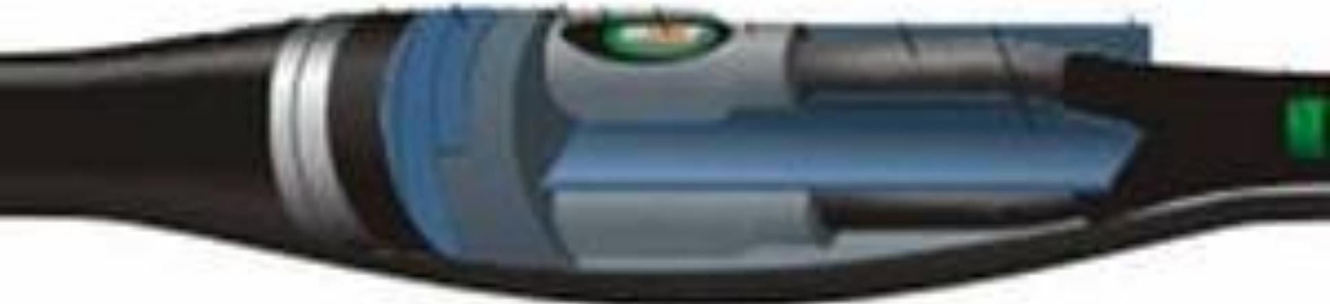
В соединительных муфтах рассчитанных на среднее напряжение (до 35 кВ) используются материалы обладающие способностью к быстрому усаживанию. В переходных муфтах применяются специальные маслостойкие трубки для того, чтобы трансформировать кабель с бумажно-масляной изоляцией (стекающей и не стекающей) в кабель с пластмассовой изоляцией с радиальным распределением электрического поля внутри нее
