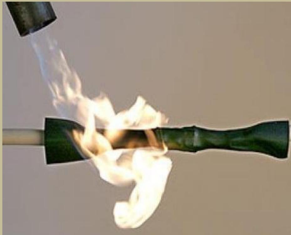
***Для чего предназначены и где используются термоусадочные муфты?*** Прежде всего муфта предназначена для соединения и оконцевания одно- и многожильных кабелей. Муфты производятся на основе термоусаживаемых материалов, т.е. материалов которые под воздействием тепловой обработки принимают нужную форму.
