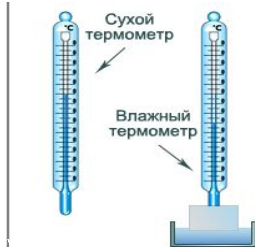
**По разнице температур сухого и влажного термометров и
