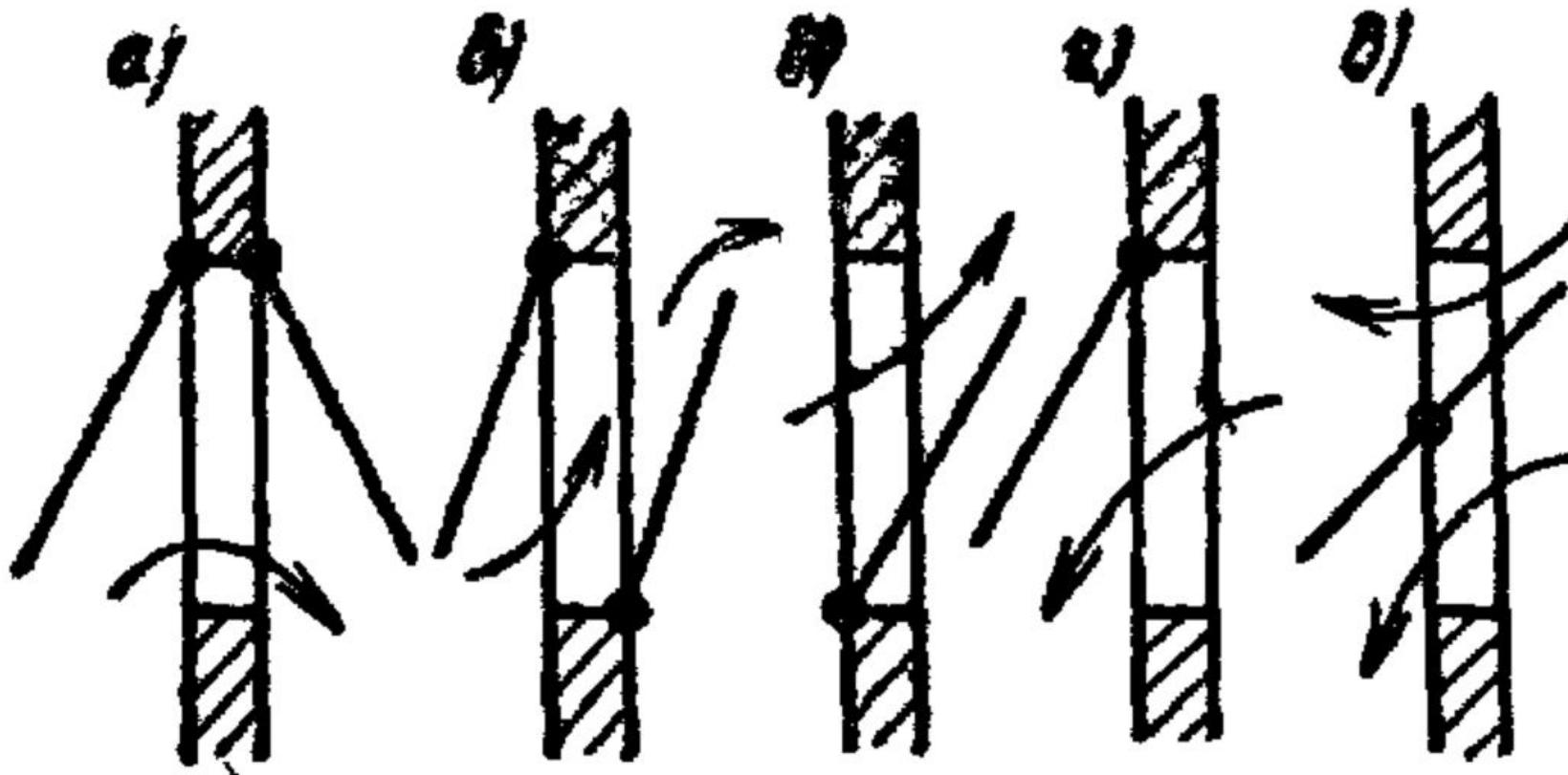
а – створки в окне с двойным остеклением для притока в нижнюю зону помещения (летом), б – то же в верхнюю зону (зимой), в – створка в окне с одинарным остеклением для притока, г – то же, для вытяжки, д – среднеподвесная створка в окне с одинарным остеклением для вытяжки.
