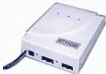
**Сетевое окончание ISDN - NT1** (Network Termination) это сетевое соединительное устройство, обеспечивающее переход с двухпроводных линий ISDN на четырехпроводные для подключения к компьютерам и терминалам. Оно устанавливается оператором связи в помещении клиента.
