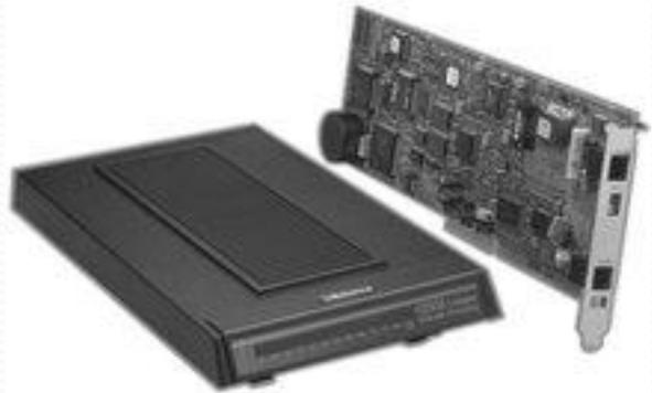
**Внутренние ТА** предназначены, в основном, для передачи данных, обеспечивая скорость передачи до 128 Кбит/с, хотя некоторые модели поддерживают передачу голоса при помощи специальных встроенных портов (POTS). Такие ТА используются для организации удаленного доступа к ресурсам локальной сети, доступа к Internet и скоростной передачи файлов.
