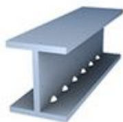
Точечная прихватка поясов к стене балки
