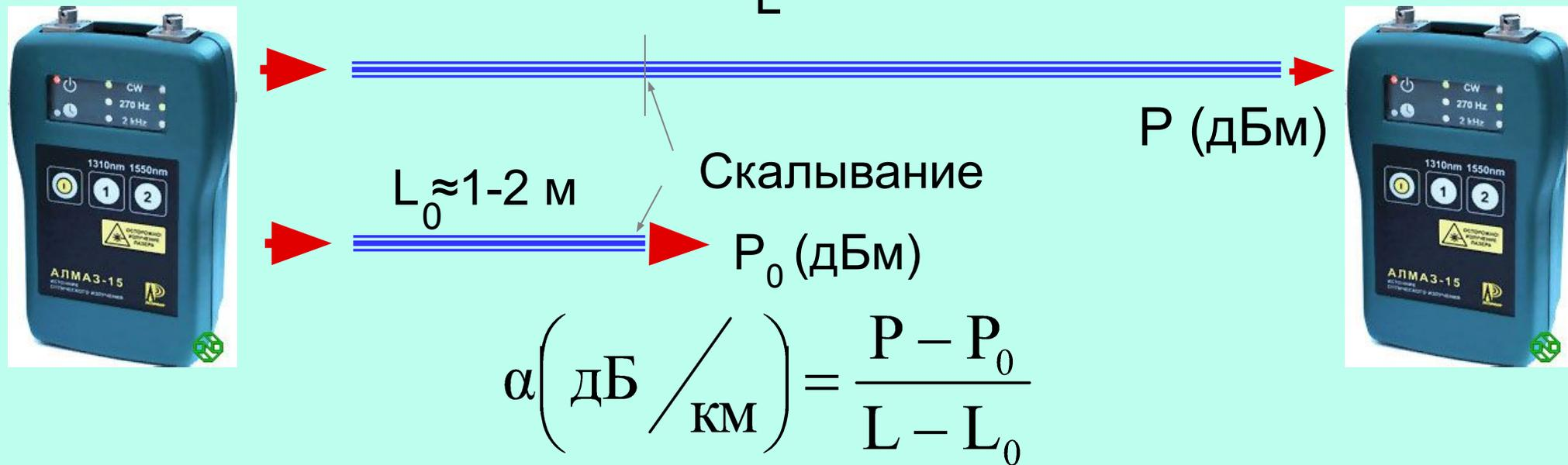
Преимуществом метода обрыва является высокая точность измерения затухания, обеспечиваемая учётом эффективности ввода излучения в волокно - путём второго измерения на сколотом волокне.
