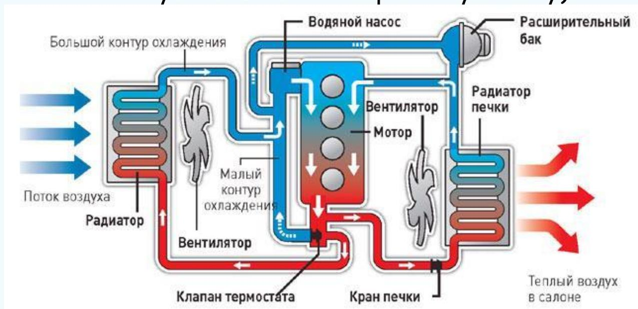
В зависимости от температуры жидкость циркулирует по малому или большому кругу. При запуске двигателя сам двигатель и охлаждающая жидкость в нем холодные. Для ускорения прогрева двигателя охлаждающая жидкость движется по малому кругу, минуя радиатор. Термостат при этом закрыт.
