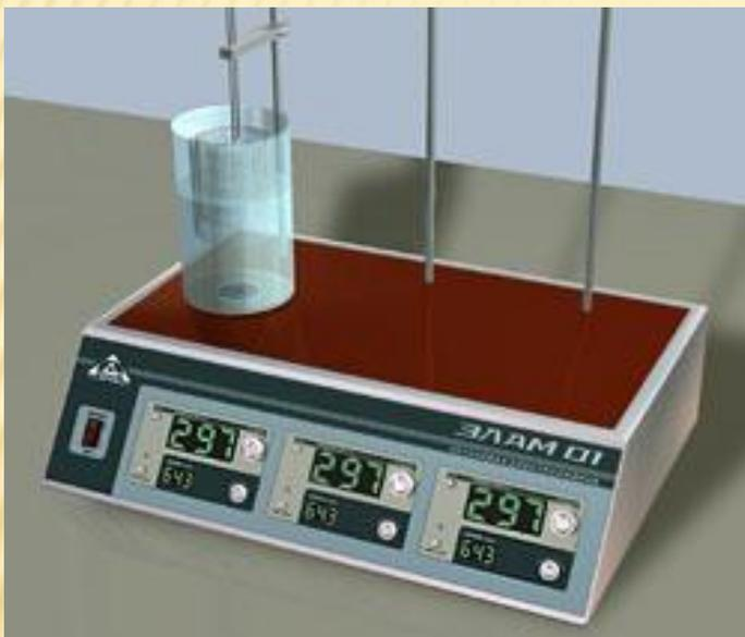
Лабораторная электролизная установка для анализа металлов «ЭЛАМ». Установка предназначена для проведения весового электролитического анализа меди, свинца, кобальта и др. металлов в сплавах и чистых металлах.
