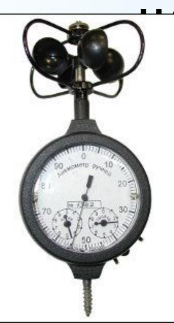
предназначен для измерения средней скорости направленного воздушного потока в промышленных условиях и средней скорости ветра на метеорологических станциях.
