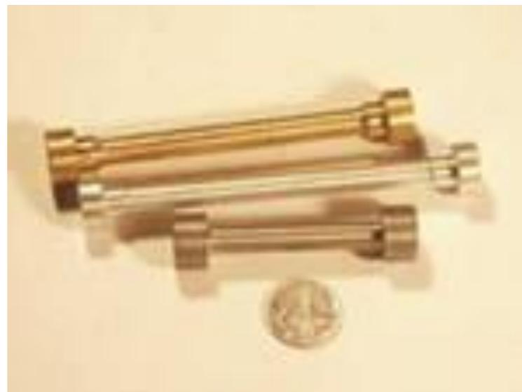
**Механические испытания на растяжение** производятся на разрывной машине, используя образцы стандартной формы и размеров.
