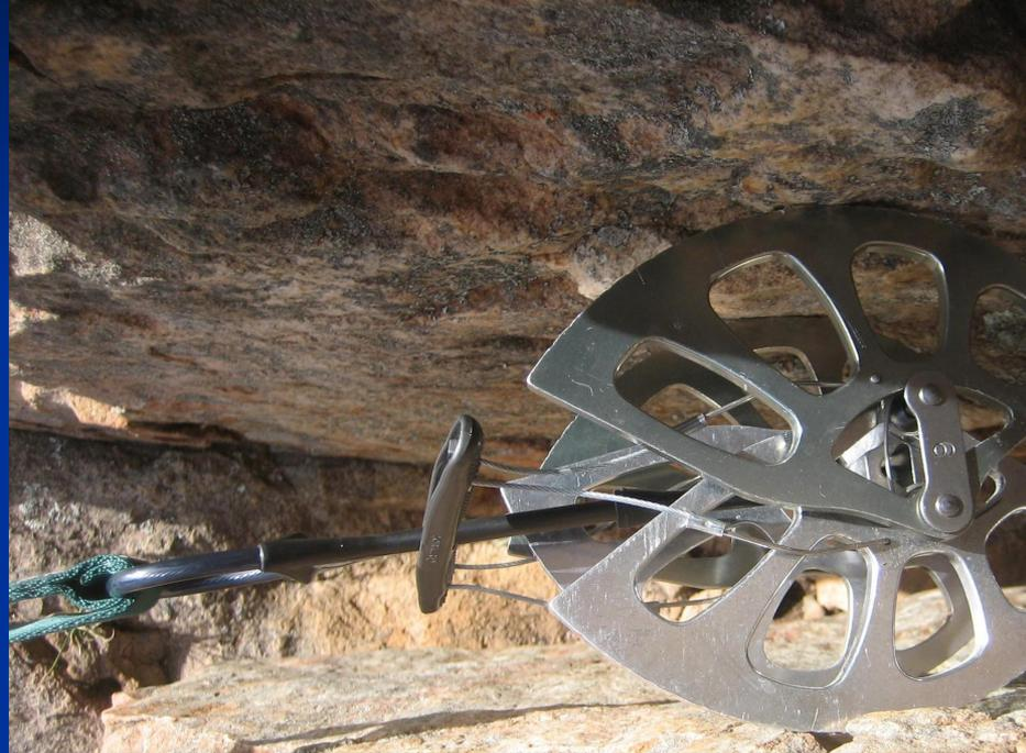
Тяжелее чем одноосевые, более стабильны, шире диапазон перекрытия, работают в полностью раскрытом положении как закладка.
