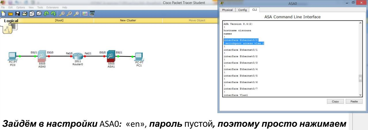
Зайдём в настройки ASA0: «en», пароль пустой, поэтому просто нажимаем <Enter», далее посмотрим заводские настройки: «show run», для продолжения просмотра нажимаем <Пробел».
