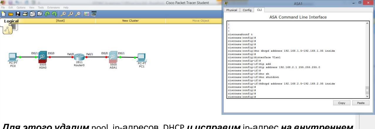
**Для этого удалим** pool ip-адресов DHCP *и исправим* ip-адрес *на внутреннем интерфейсе* (vlan 1): «conf t», «no dhcpd address 192.168.1.5-192.168.1.35 inside», «interface Vlan1», «ip address 192.168.2.1 255.255.255.0», «no shutdown». **Добавим новый** pool: «dhcpd address 192.168.2.5-192.168.2.35 inside».
