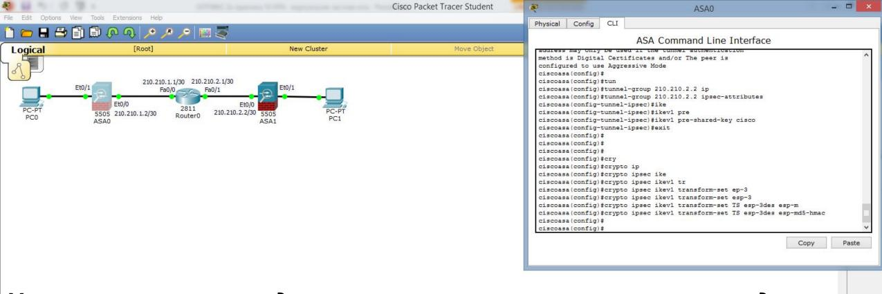
Указываем параметры для построения ipsec-туннеля с именем TS, далее указываем алгоритм шифрования и хэширования:
