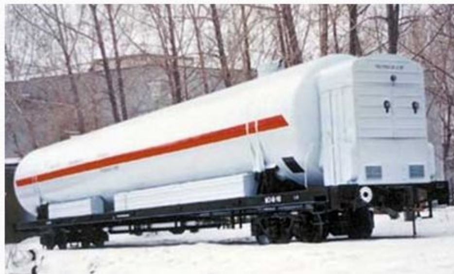
Железнодорожная цистерна для перевозки жидкого водорода. Вместимость 7350 кг.
