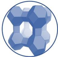
Предназначен для глубокой осушки природного и попутного нефтяного газа. Обладает повышенной износостойкостью и адсорбционной активностью по сравнению с аналогами. Адсорбент обеспечивает стабильно низкую точку росы товарного продукта.
