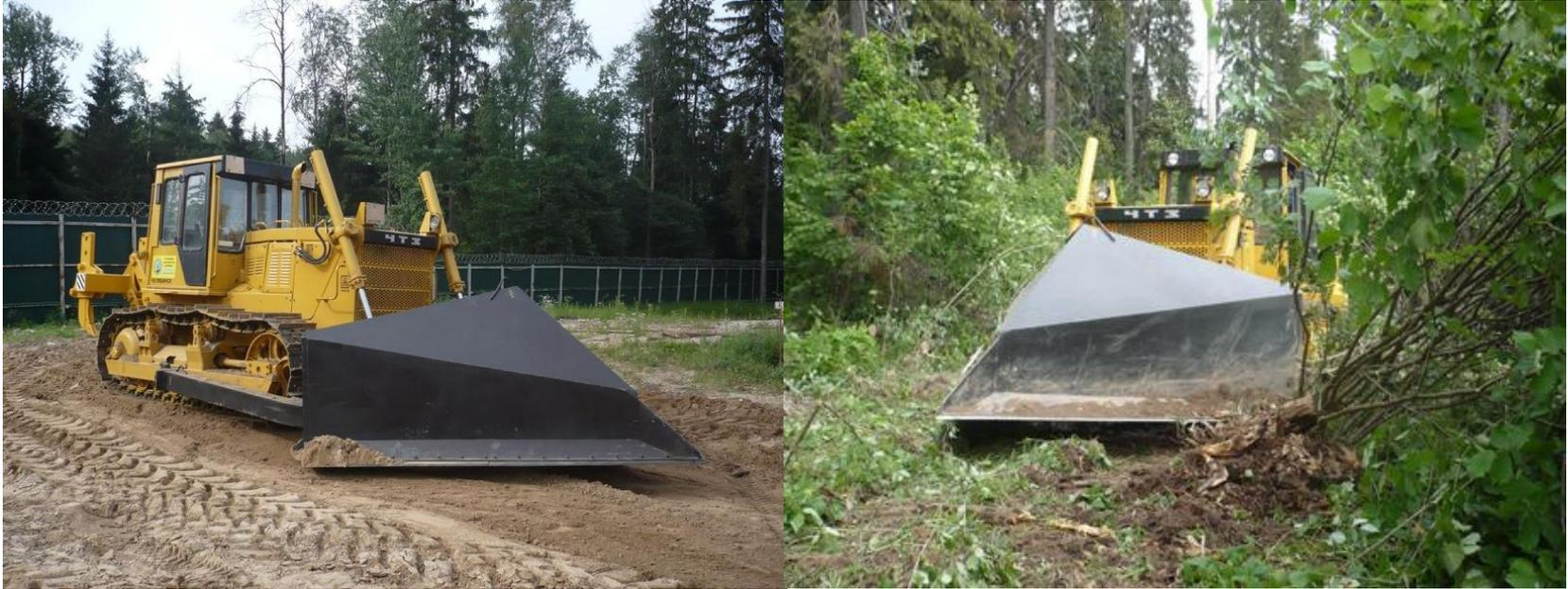
Челябинского трактор Т-10М, оборудован навесным устройством – кусторезом, предназначенным для очистки лесных территорий от кустарника и молодой поросли толщиной до 120 миллиметров. Агрегат, представляющий собой бульдозер ЧТЗ с внушительным клиновидным отвалом, оснащенный ножами-лезвиями.
