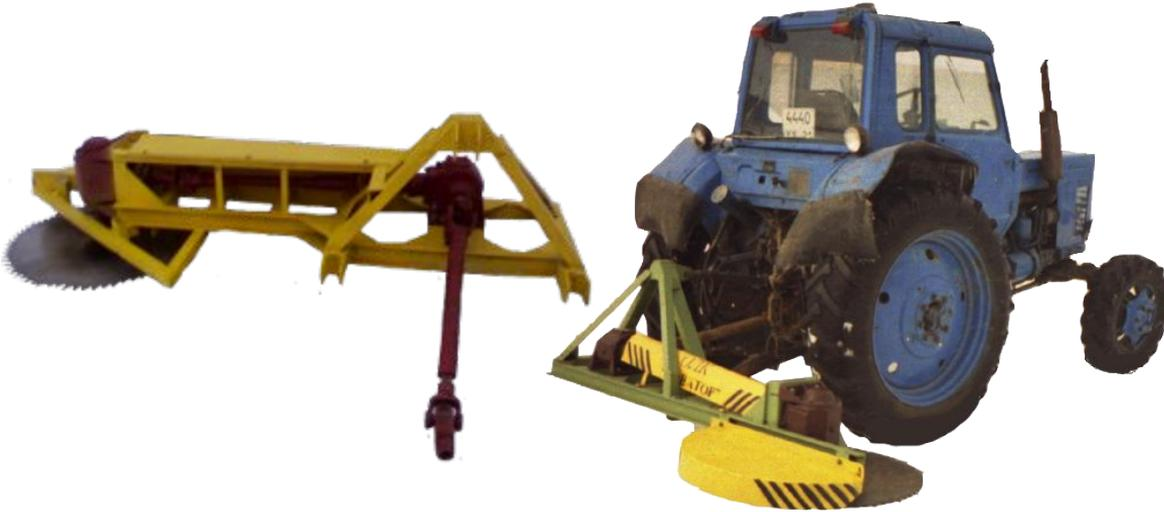
Предназначен для механизированного удаления нежелательной древесно-кустарниковой растительности выносной дисковой пилой, размещенной сбоку трактора, при осветлении лесных культур, а также при уходе за состоянием автомобильных дорог и обслуживании линий электропередач.
