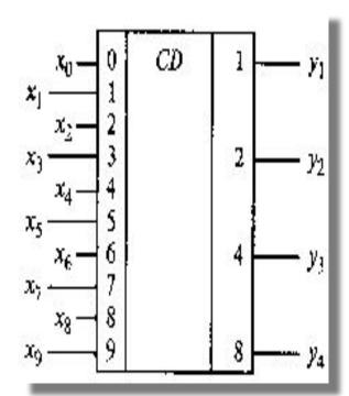
**Шифратор** — цифровые микросхемы, выполняющие обратную операцию шифратора: переводит канал, поданный только на один вход в выходной параллельный двоичный код.
