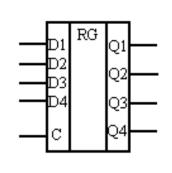
Регистры ЭТО функциональные устройства для хранения чисел с двоичным цифр представлением разряда, применяются для накопления сдвига Регистр представляет собой данных. последовательное соединение нескольких триггеров, при этом в отличии от счетчика делителя, нет него внутренних запрещающих обратных связей.
