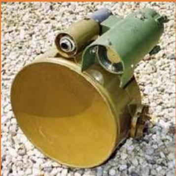
Поражение машинам противника наносится за счет пробивания бортовой брони ударным ядром, образующимся из обкладки кумулятивной воронки при взрыве мины.
