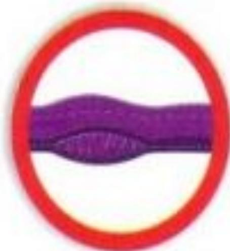
местные расслоения лент на суммарной длине более 50 мм с разрывом трех и более строчек одного крайнего или двух и более внутренних швов
