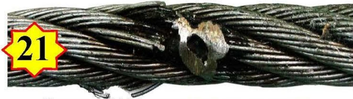
**Рисунок 21** Повреждения в результате воздействия на канат внешних факторов: высоких температур (открытого огня) или электрического дугового разряда (действие кислот, щелочей, сварки и т.п.)
