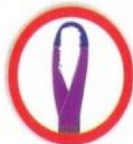
размочаливание или износ более 10% от ширины петель стропа
