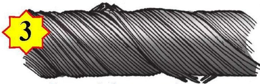
**Рисунок 3.** Сочетание обрывов с их износом в канате односторонней свивки
