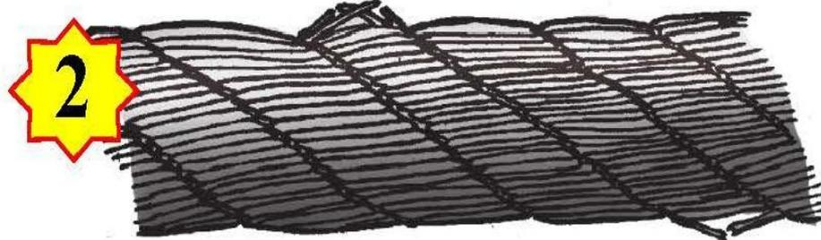
**Рисунок 2.** Сочетание обрывов с их износом в канате крестовой свивки
