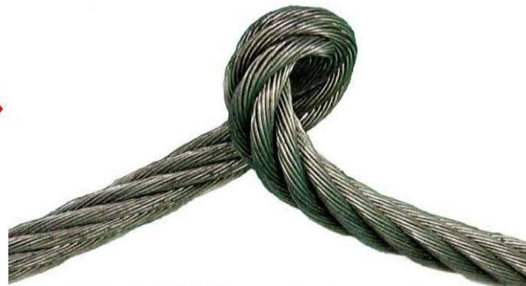
Рисунок 20 Перекручивание каната
