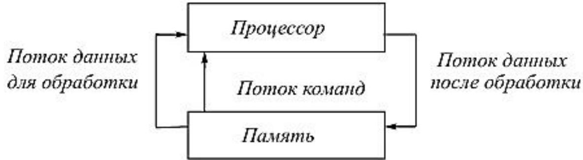
Рисунок 8 – Структура вычислительного процесса SISD
