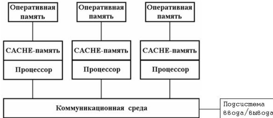
Рисунок 12 – MPP архитектура ЭВМ
