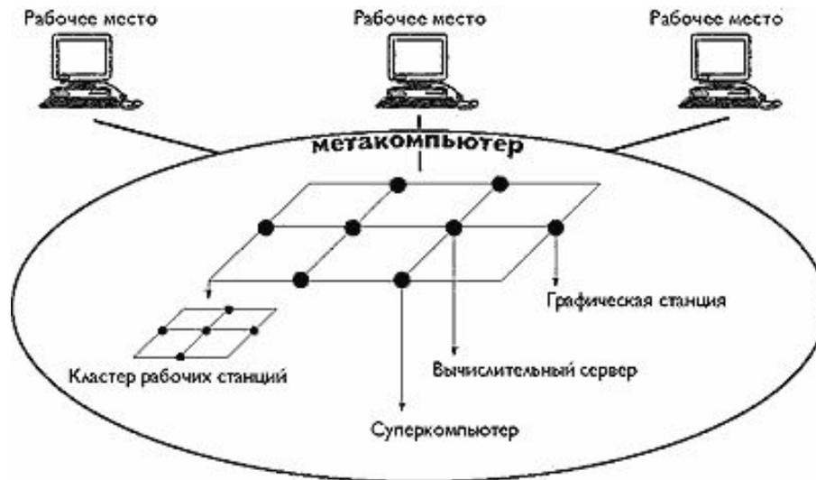
Рисунок 14 – Типы узлов метакомпьютера
