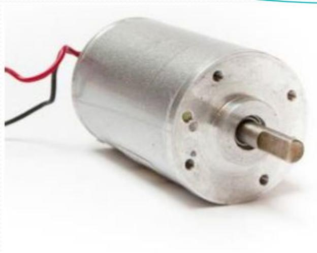
*При использовании источника постоянного тока, для управления подобным двигателем практически ничего не надо. Скорость его вращения зависит от силы тока, которая поступает на катушки от источника питания к коммутатору. Для вращения оси двигателя в противоположном направлении, достаточно подключить контакты от источника питания к двигателю наоборот.*
