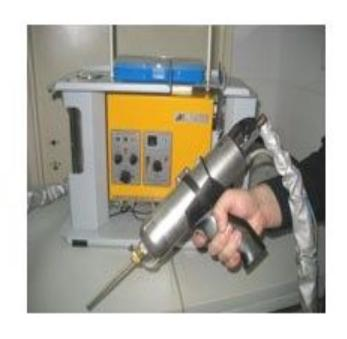
Технология газодинамического напыления металлов ДИМЕТ® включает в себя нагрев сжатого газа (воздуха), дальнейшее поступление его в сверхзвуковое сопло с формированием в сопле воздушного потока сверхзвуковой скорости.
