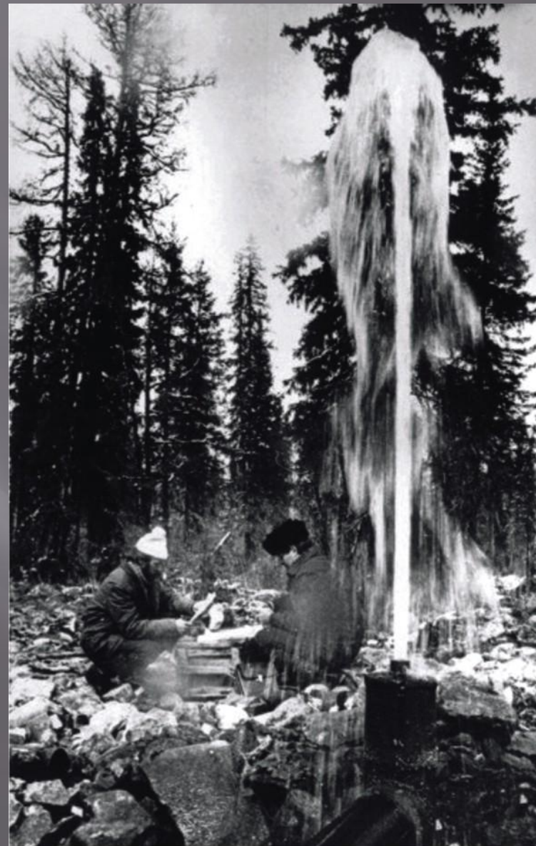
Фонтанирующая гидрогеологическая скважина, вскрывшая напорные подземные воды (Южная Якутия).
