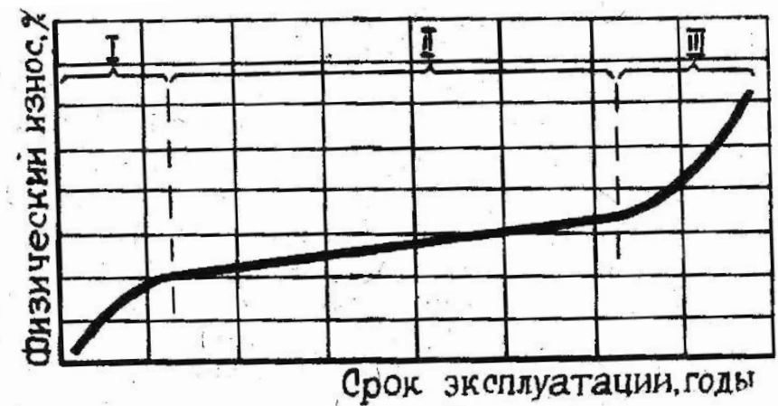
Рис. 2. Обобщенный график изменения физического износа промышленного объекта в процессе эксплуатации
