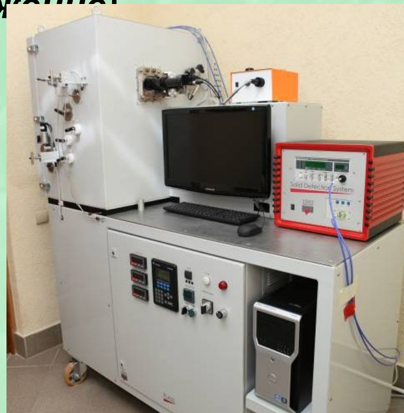
Лазерный анализатор твердых частиц в пластовой нефти FLASS (Vinci Technologies)
