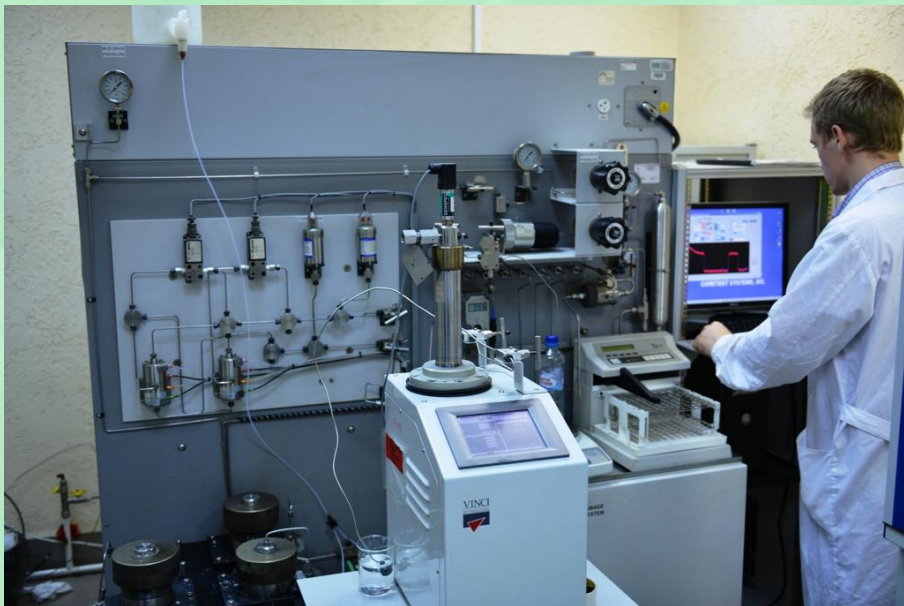
Система оценки степени повреждения пласта FDES-645 (Coretest Systems Corporation)
