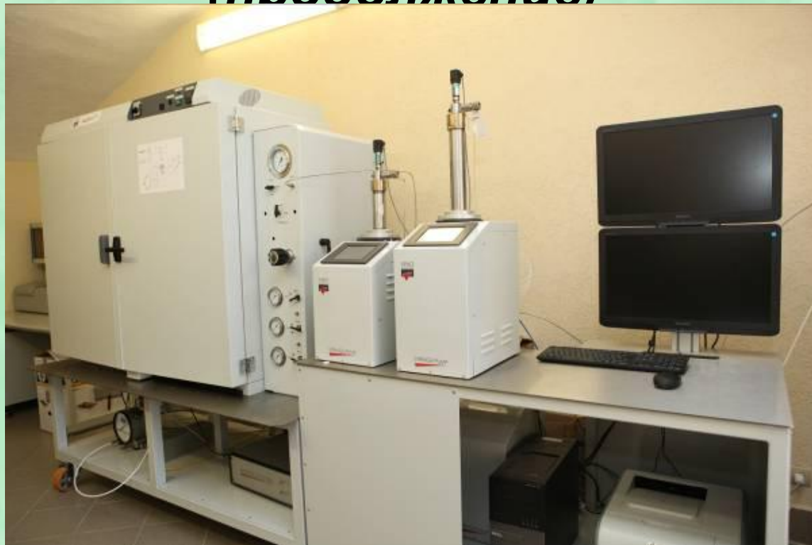
Система для исследования нефтывтеснения из модели пласта Autoflood-700, с рентгеновским сканером (Vinci Technologies)
