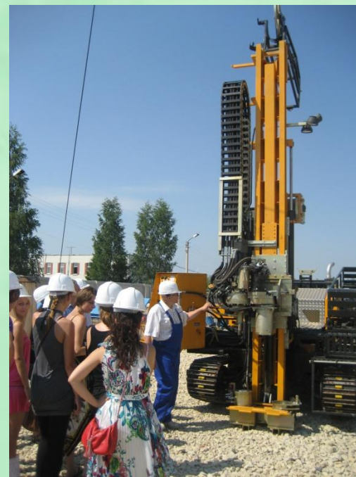
Установка GM-200 для гидроударного и алмазного бурения
