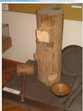
Приспособление для получения подсолнечного масла, изобретено Бокаревым в 1829 году
