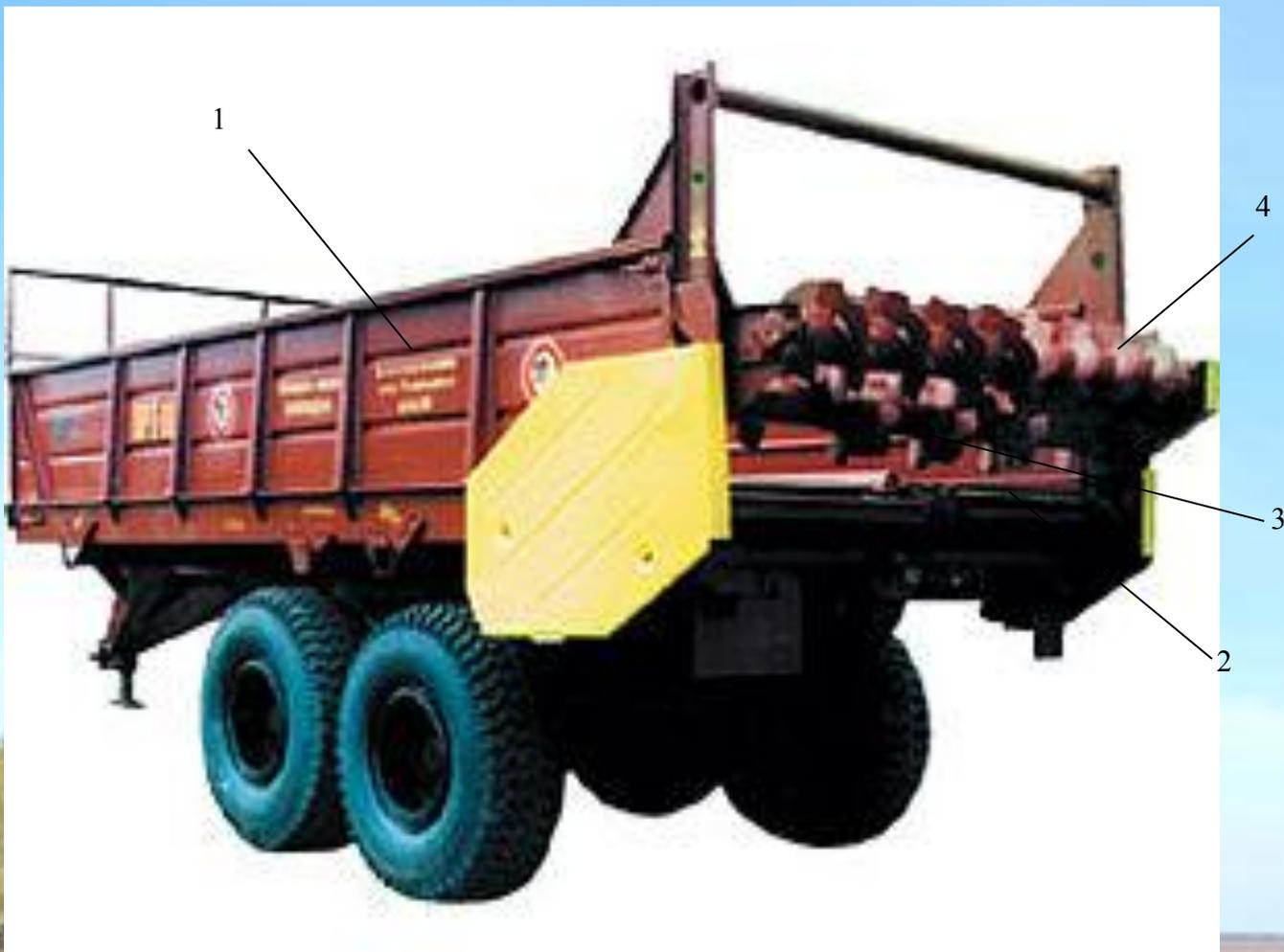
**1—кузов; 2—транспортер; 3—измельчающий барабан; 4—разбрасывающий барабан**
