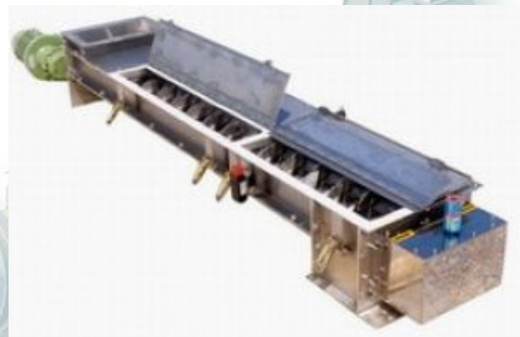
Двухвальный шнековый смеситель непрерывного действия
