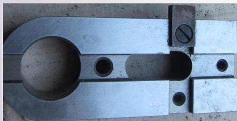
**Прижимные детали:** прихваты, откидные и передвижные планки, быстросъемные шайбы служат **для непосредственного воздействия** на обрабатываемую заготовку при ее закреплении.
