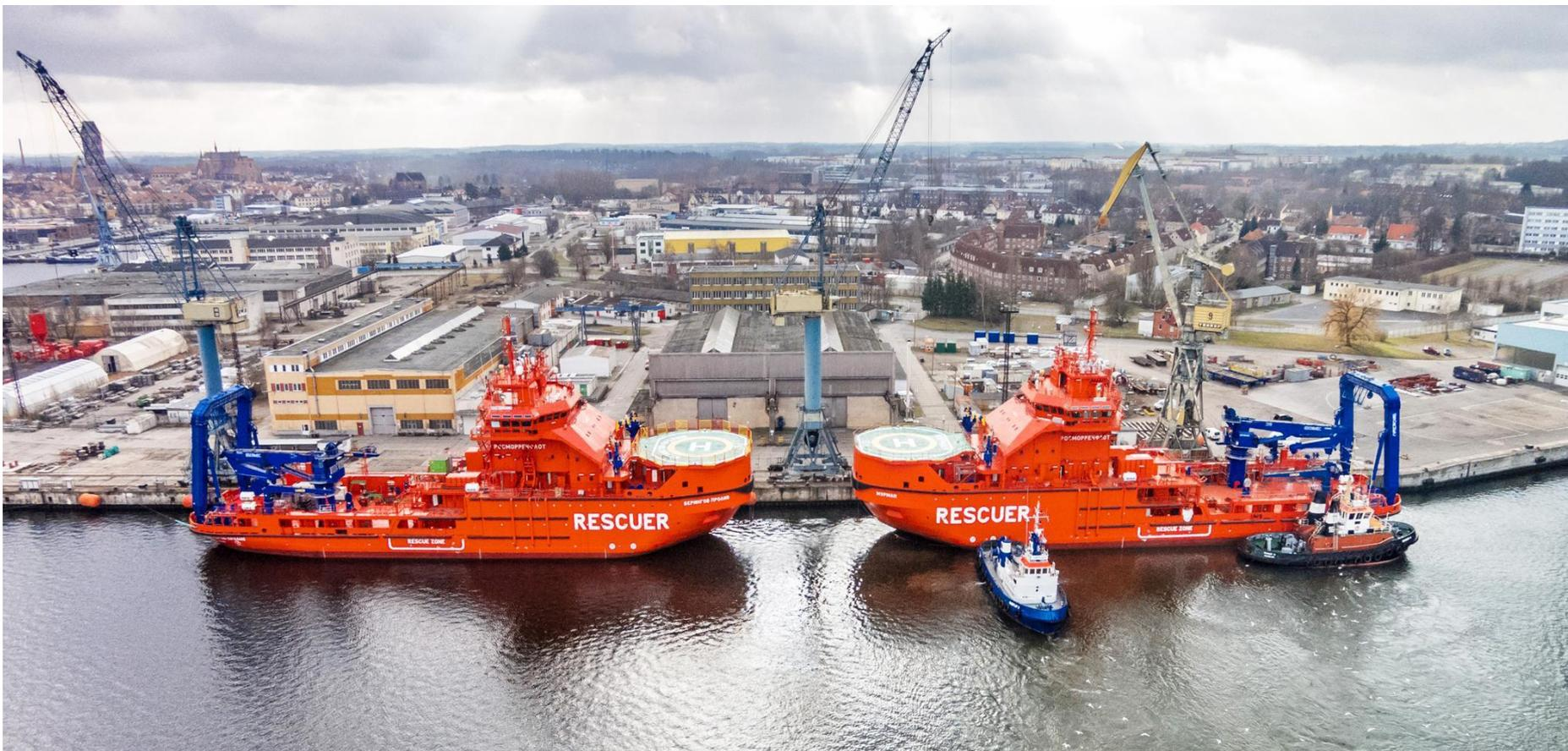
Судно неограниченного района плавания с усиленным ледовым классом с наклонным форштевнем и крейсерской кормовой оконечностью, с удлиненной двухъярусной надстройкой бака, носовым расположением жилой надстройки и вертолетной площадки, машинным отделением в средней части, с дизель-электрической энергетической установкой, с двумя полноповоротными винторулевыми колонками.
