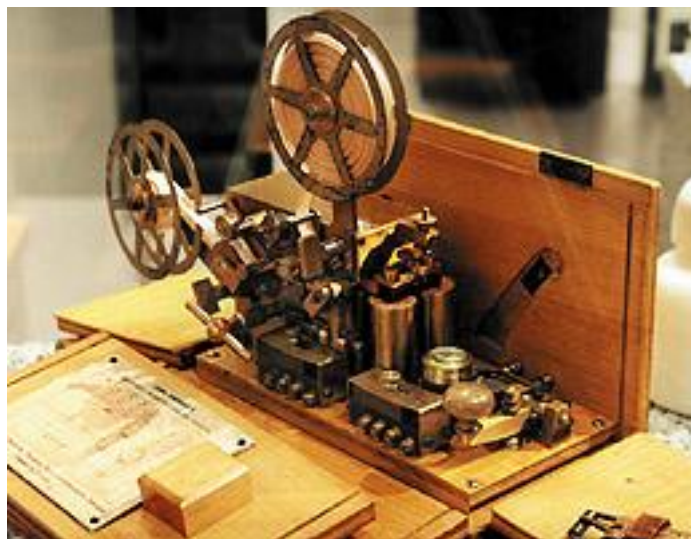
Рис. 1.3. Пишущий телеграфный аппарат Морзе, выпущенный заводами "Сименс и Гальске" в России
