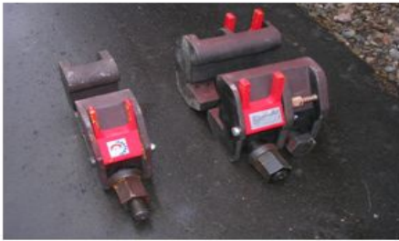
Рисунок 1 Одинарная (шириной 70 мм) и двойная (шириной 140 мм) трубки ПСС-36
