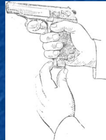
Рис. 8. Вставление магазина в основание рукоятки
