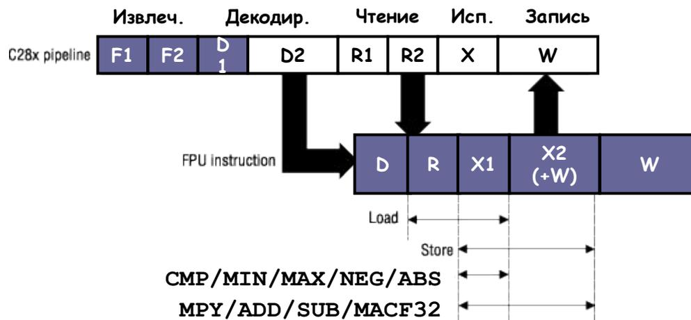
Компилятор C/C++ автоматически оптимизирует алгоритм пользователя с учетом возможного параллельного выполнения команд, добавляя, как правило, «не конфликтующие с конвейером» команды загрузки операндов, которые понадобятся на следующих этапах вычислений. Тем самым практически полностью исключаются непроизводительные задержки конвейера.
