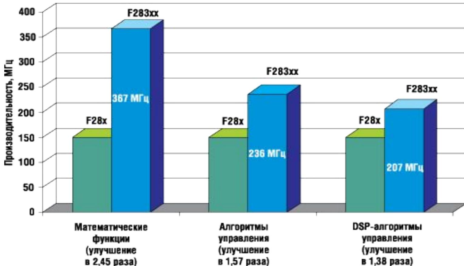
Эквивалентная частота, например, 367 МГц означает, что разработчик, использующий C2812, должен был разогнать процессор до 367 МГц, чтобы получить производительность C28335.
