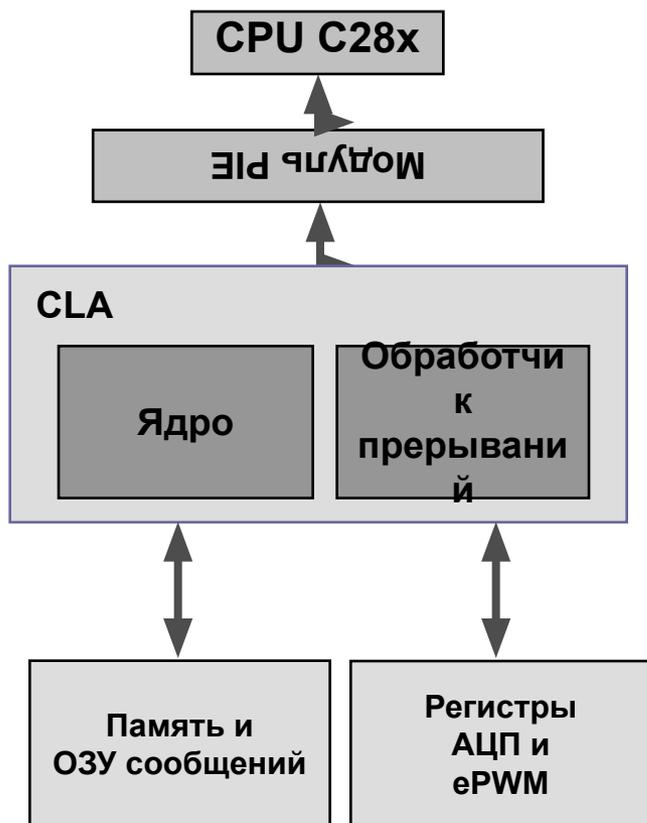
Серия Piccolo C2803x содержит независимый 32-битный математический акселератор плавающей точки (CLA, Control Law Accelerator), который сокращает загрузку CPU, предоставляя возможность увеличения функционала.
