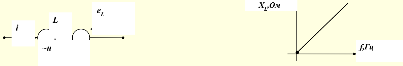
Рисунок 4 - Позначення індуктивного опору в схемах (1) та його залежність від частоти струму (2)
