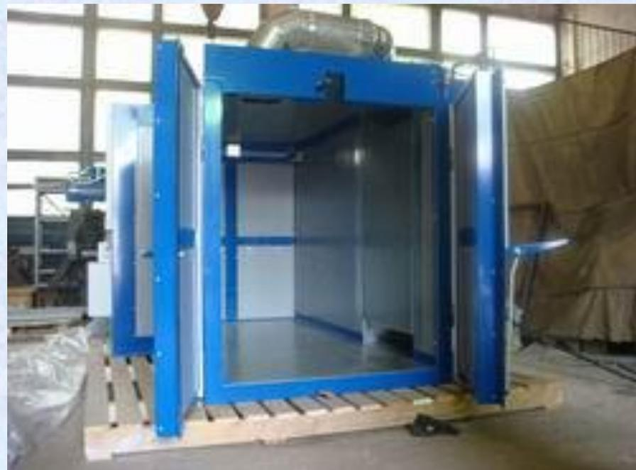
Сушильные устройства бывают периодического (**тупиковые камеры**) и непрерывного (**проходные камеры**) действия (рис. 1, 2).
