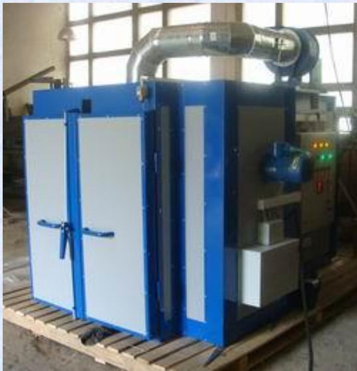
В устройствах для **конвекционной сушки** передача тепла происходит при непосредственном контакте горячего воздуха и детали. Чтобы исключить влияние окружающей среды, окрашенные изделия помещают в специальные теплоизоляционные устройства – **камеры (шкафы, печи)**.
