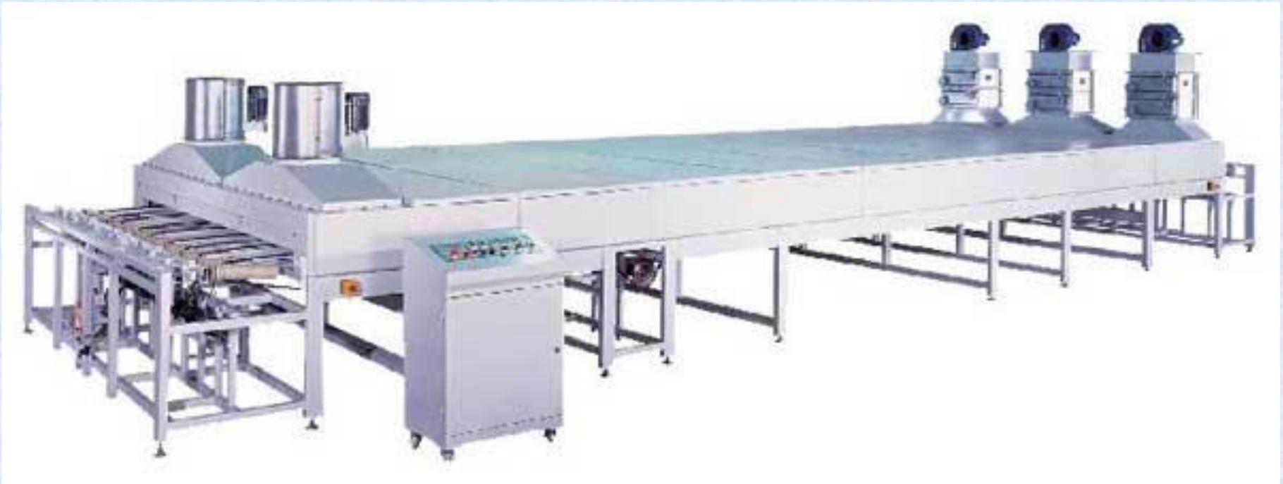
**Терморадикационная сушка** основана на передаче тепла с помощью лучистой энергии (инфракрасных лучей). Тепло передается мгновенно, без потерь, так как инфракрасные лучи проходят через воздух со скоростью света и не теряют при этом энергии. Поэтому температура изделия быстро повышается и сушка ускоряется.
