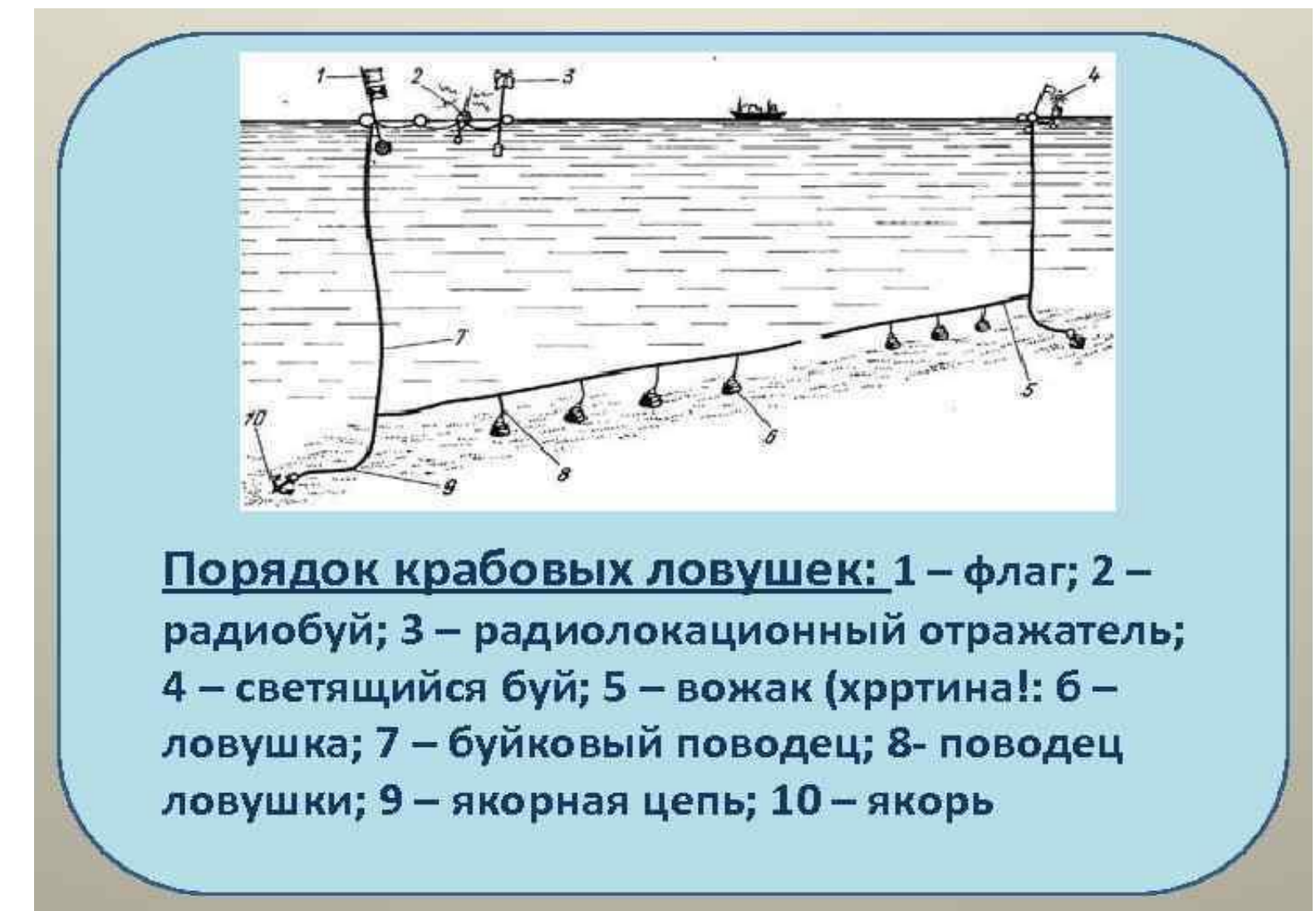
Рис. 11. Схема установки крабовых ловушек с судна.
