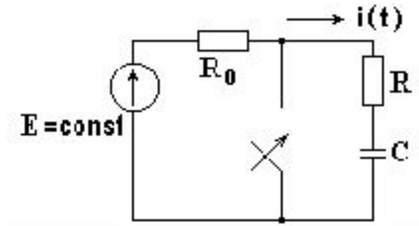
В схеме в результате коммутации рубильник замыкается, и образуется замкнутый на себя  $R - C$  контур.
