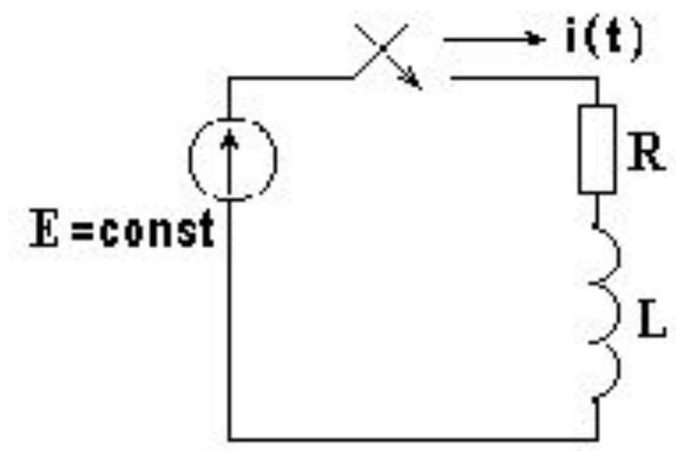
В схеме на рисунке 2 до коммутации рубильник разомкнут. В результате коммутации рубильник замыкается и подключает  $R - L$  цепь к источнику постоянной ЭДС. Определим закон изменения тока  $i(t)$ .
