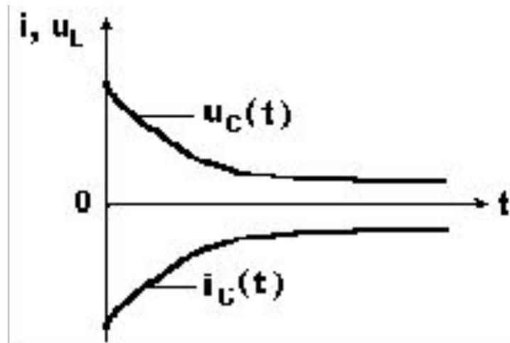
Переходный ток и переходное напряжение на конденсаторе по показательному закону уменьшаются до нуля
