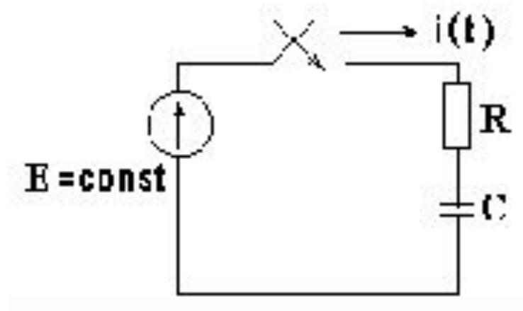
Полагаем, что до коммутации конденсатор не заряжен, напряжение на нем  $u_C(0_-) = 0$ .
